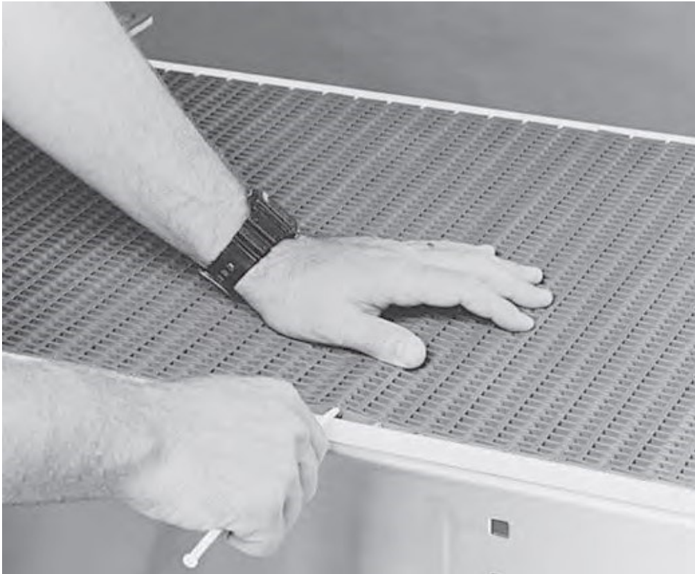
Kuva 4. Saranatangolla yhdistettyjä muovi moduuleja (Intralox LLC, 2022, s. 6).
