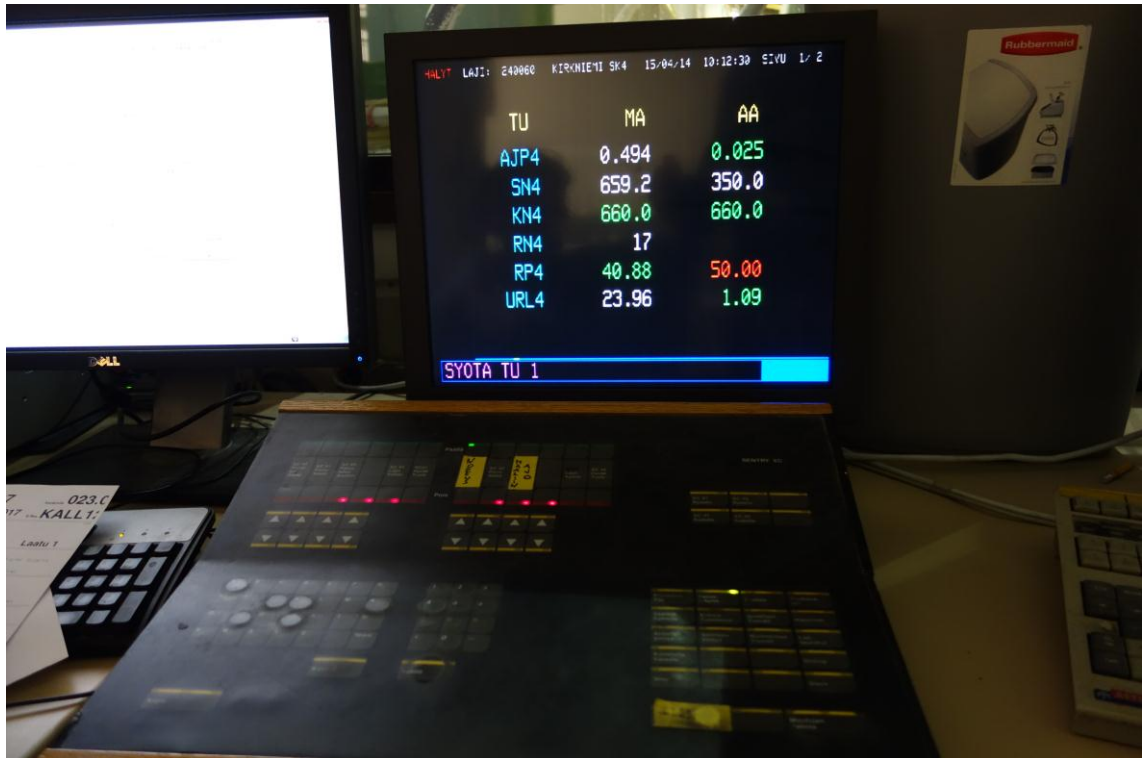
Kuva 11. Sentryn ajonäyttö. Kohtaan AJP4 AA syötetään maalinajon ohjearvo (mm). AJP4 MA kohdassa näkyy mitattu hetkellisarvo (mm).
