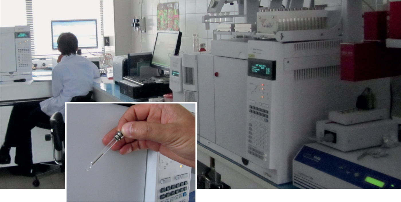
Kuva 8.4 SBSE-menetelmän laitteistoa ja näytepullo Cedren laboratoriossa, Brest, Ranska (M. Pascale 2010). Menetelmä on käytössä myös Suomessa.
