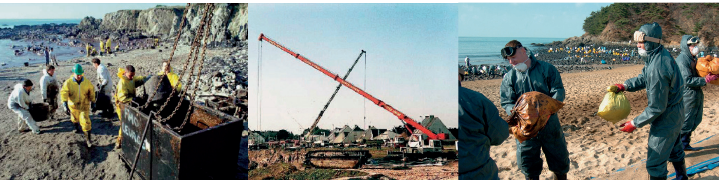
Kuvat 10.3, 10.4 ja 10.5 Vinssin ja ihmisketjun käyttö vahinkojätteen siirtämiseen (10.3 ja 10.4 Cedre, 10.5 Photo Courtesy of U.S. Army).
