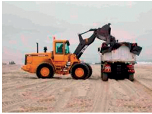
Kuvat 15.4 ja 15.5 Koneellinen työskentely mahdollistaa kuormaamisen suoraan ajoneuvoihin (Cedre).
