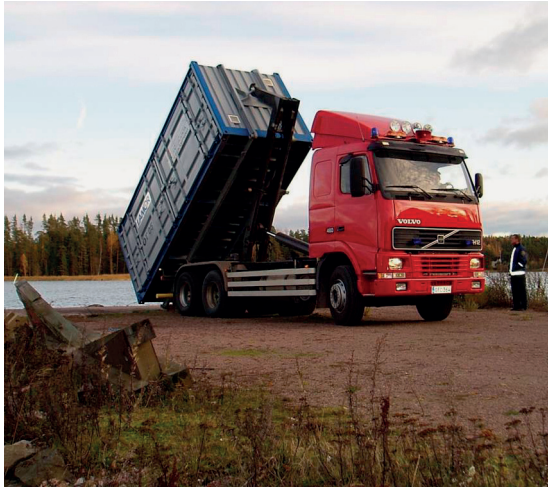
Kuva 15.1 Koukkulavallaitteella varustettu kuorma-auto (L. Ekholm 2010).
