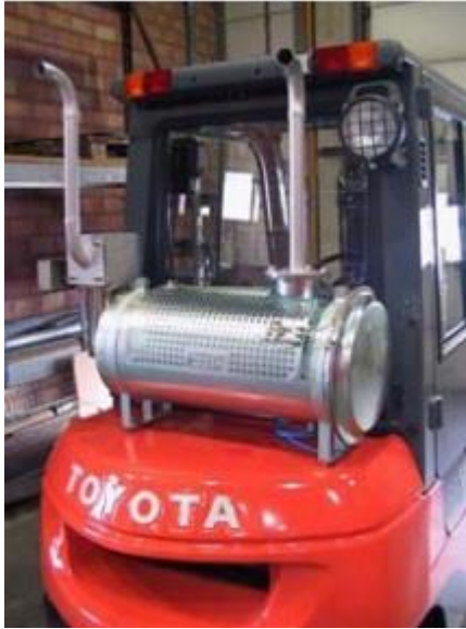
Kuvio 8. YTM HC -suodatin Toyotan haarukkatrukissa. (YTM-Industrial 2013.)
