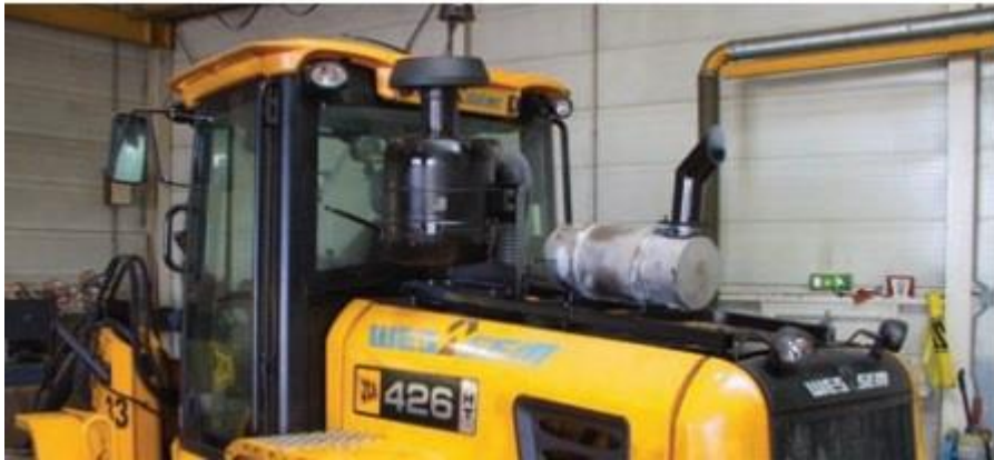
Kuvio 9. EHC PF asennettuna JCB:n kuormaajaan. (YTM Industrial 2013.)
