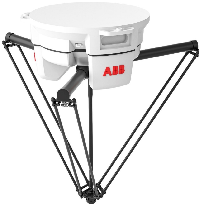
Kuva 4: Rinnakkaisrakenteinen robotti (br-automation, n.d.)
