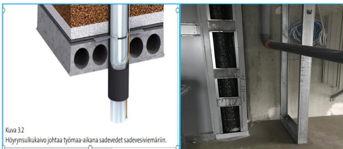
Kuva 3. Höyrynsulkukaivo (3) Kuva 4. Vedenohjaus vesikaton alapuolella.(3)
