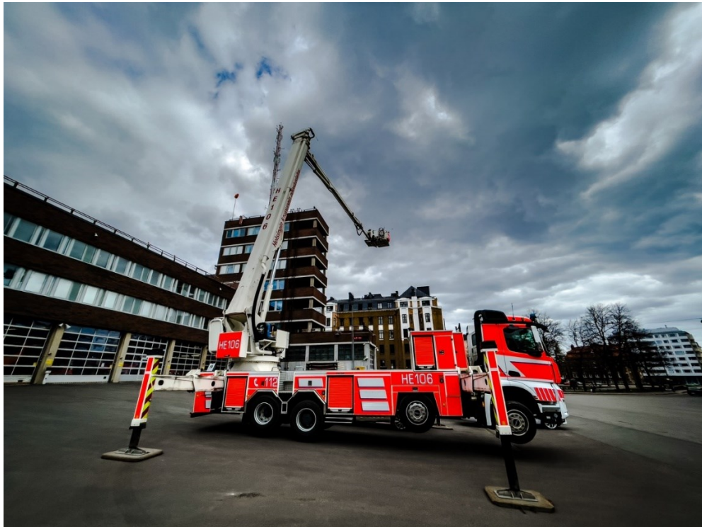
Kuvio 3. Nostolavayksikkö RHE106 pedattuna tukijalkojensa varaan (Helsingin kaupungin pelastuslaitos)
