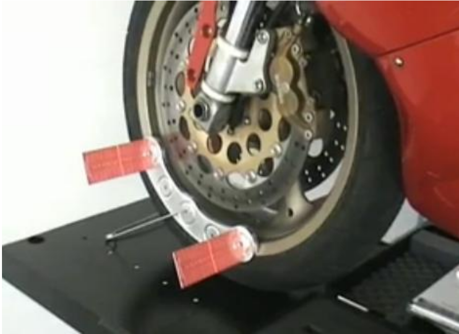
Kuvio 26. Etupyörän indikaattorilevyasetelma. (Profi Products, [Viitattu 29.1.2010].)
