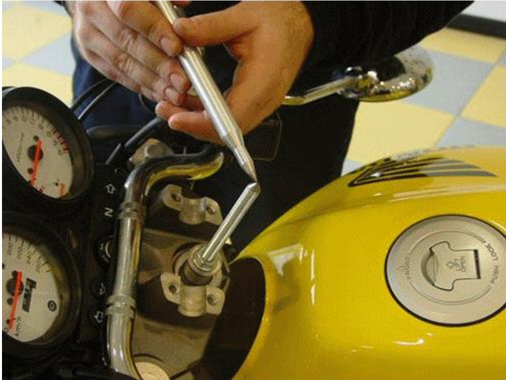
Kuvio 18. Emäputken keskilinjan mittaus adapterin yläpäätä. (Spanesi Automotive Equipment, [Viitattu 29.1.2010].)
