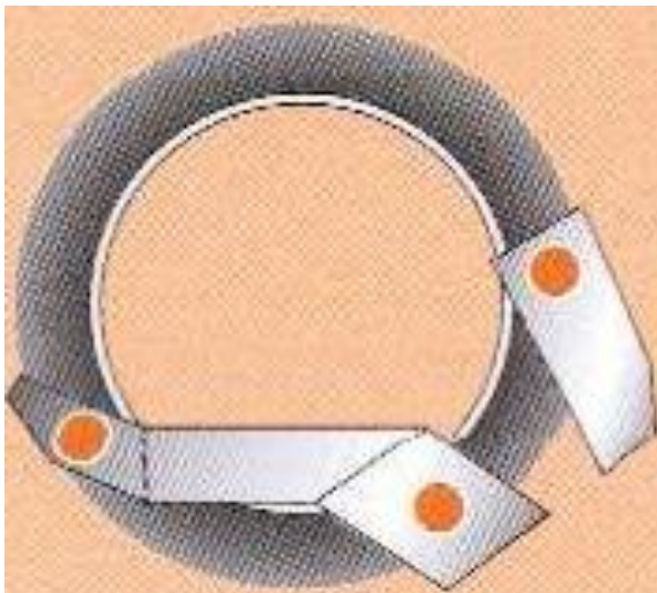
Kuvio 31. SAFE-kiinnityslaitteen tukipisteet. (Fuchs, [Viitattu 29.1.2010].)
