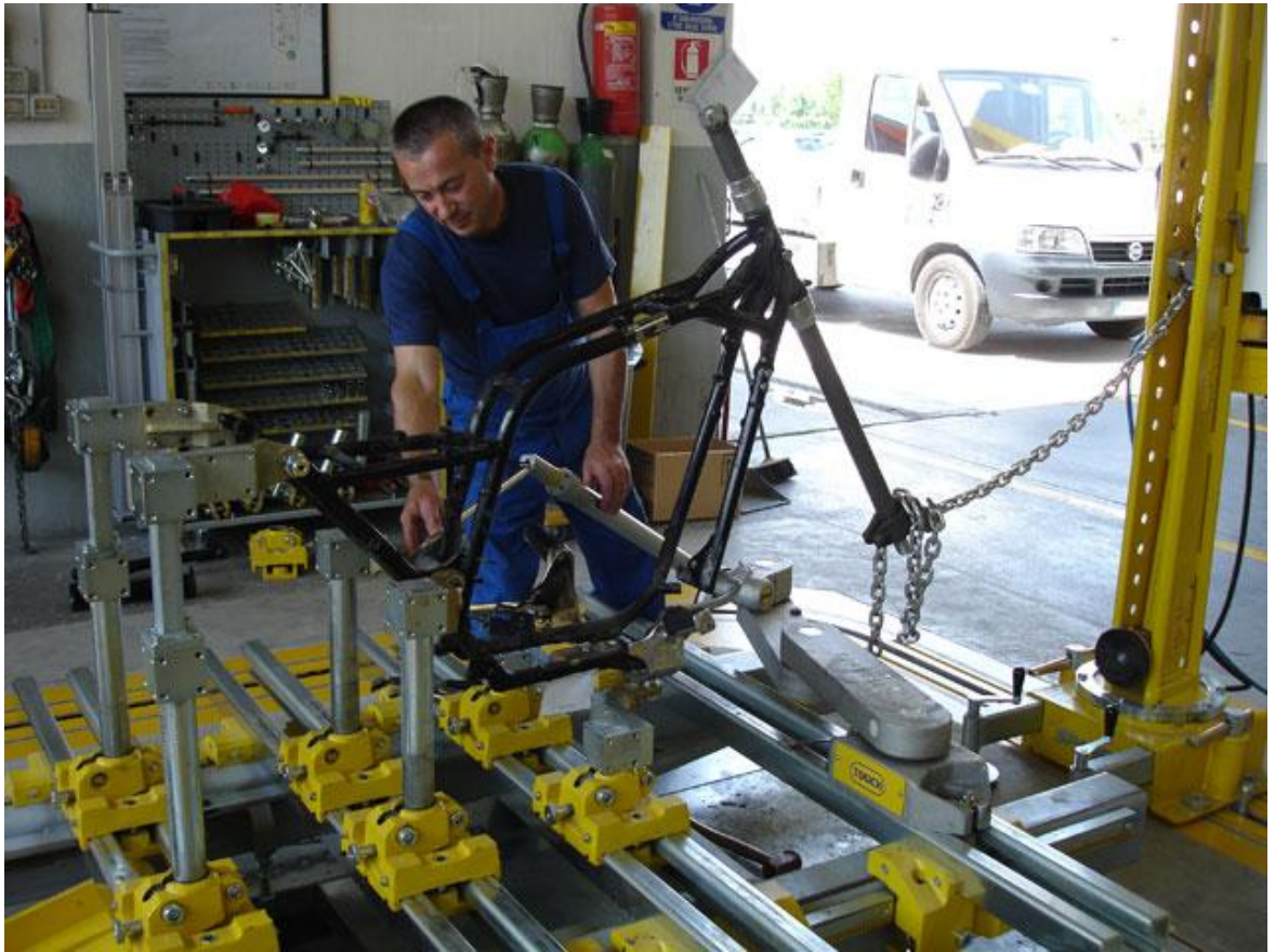
Kuvio 21. Mittaustapahtuma ajoneuvon ollessa kiinnitettynä runkopenkkiin. (Spanesi Automotive Equipment, [Viitattu 29.1.2010].)
