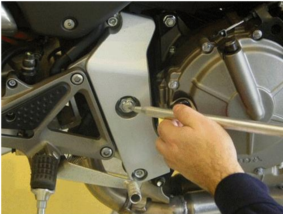
Kuvio 16. Takahaarukan akselin keskipisteen paikallistaminen pyörän oikealta sivulta. (Spanesi Automotive Equipment, [Viitattu 29.1.2010].)
