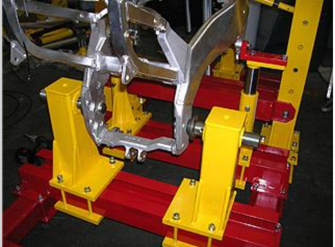
Kuvio 45. Rotobiken kiinnitysmenetelmä takahaarukan akselin rei'istä. (Rotobike, [Viitattu 29.1.2010].)
