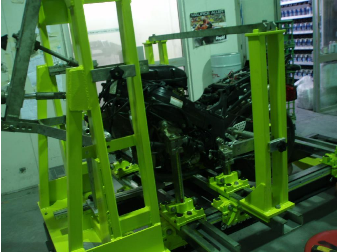
Kuvio 52. Taaempana oleviin runkopalkkeihin on mahdollista kiinnittää pystypalkkeja hydraulikkasyliintereitä varten. (Blueprint Engineering, [Viitattu 29.1.2010].)
