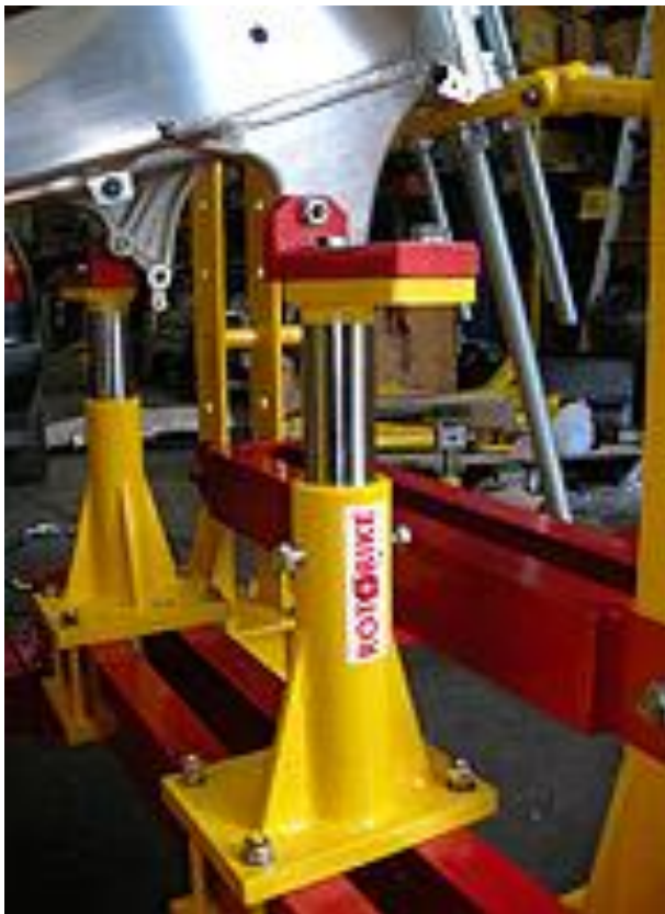
Kuvio 47. Rungon kiinnittäminen Rotobiken penkkiin moottorin kiinnityskorvakkeista. (Rotobike, [Viitattu 29.1.2010].)
