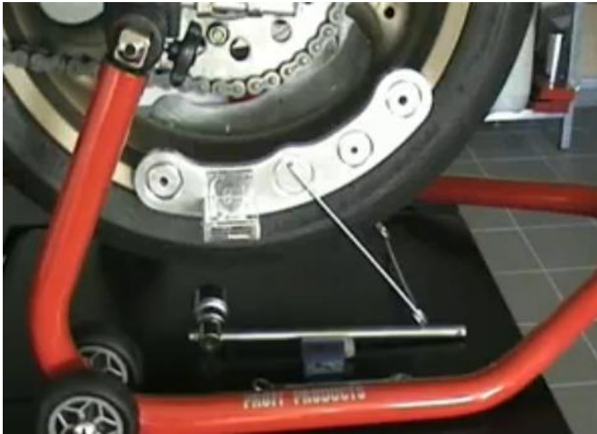
Kuvio 25. Takapyörään kiinnitettävä laserlähetin. (Profi Products, [Viitattu 29.1.2010].)
