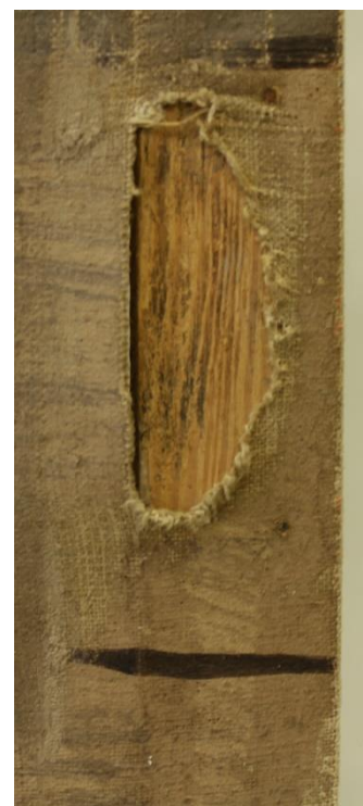
Kuva 27. Kulissi 3 d-muotoinen reikä (Penttinen 2022)
