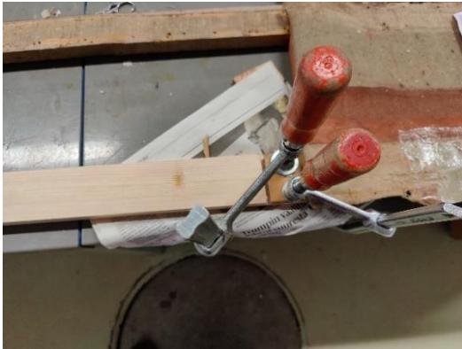
Kuva 45. Kulissi 2 lapaliitos puristuksessa (Laasasenaho 2022)
