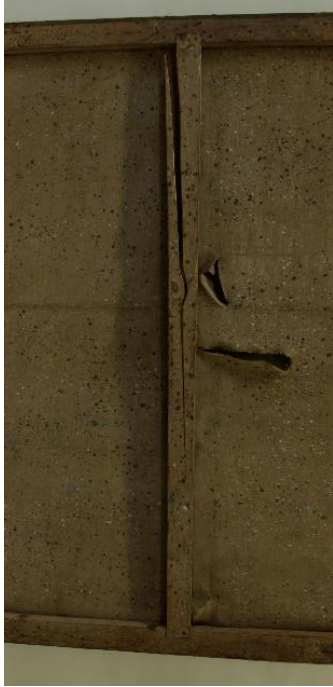
Kuva 43. Kulissi 3 haljennut tukipuu (Laasasenaho 2022)
