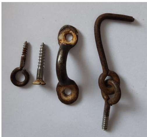
Kuva 35. Ruosteiset kiinnikkeet (Laasasenaho 2022)
