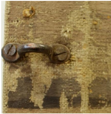
Kuva 28. Kulissi 3 ruostunut kiinnike (Penttinen 2022)
