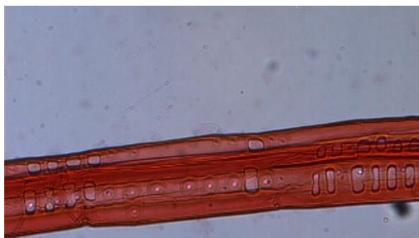
Kuva 30. Maseroitu puunäyte (Penttinen 2021)
