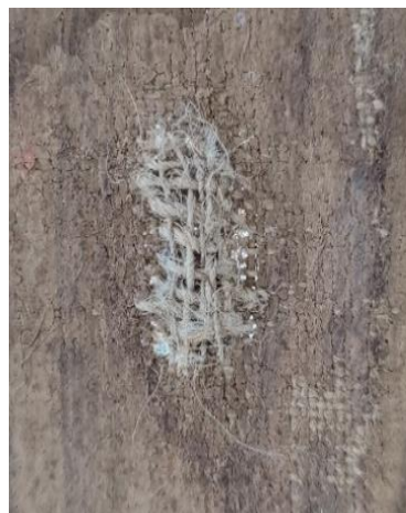
Kuva 39. Kulissi 3 pieni reikä parsittuna (Penttinen 2022)
