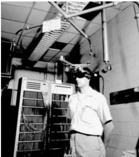
Kuva 8. Damoklees miekka käytössä Massachusetts Institute of Technologysa vuonna 1968 (33).
