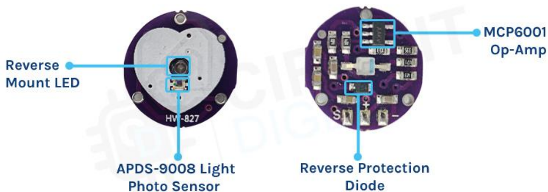
Kuva 17. PulseSensor-sensorin komponentit (48).
