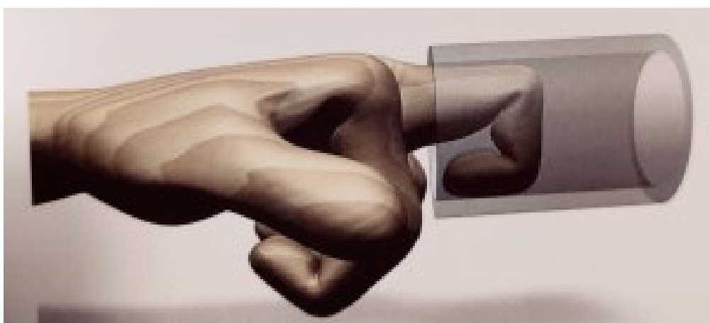
KUVA 5. Sormen kiilautuminen putken päähän (1)
