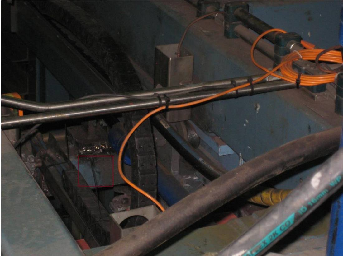
Kuva 27 Sylinterin uusi kiinnityspiste palkin sivussa. (Yliverronen. 2014)
