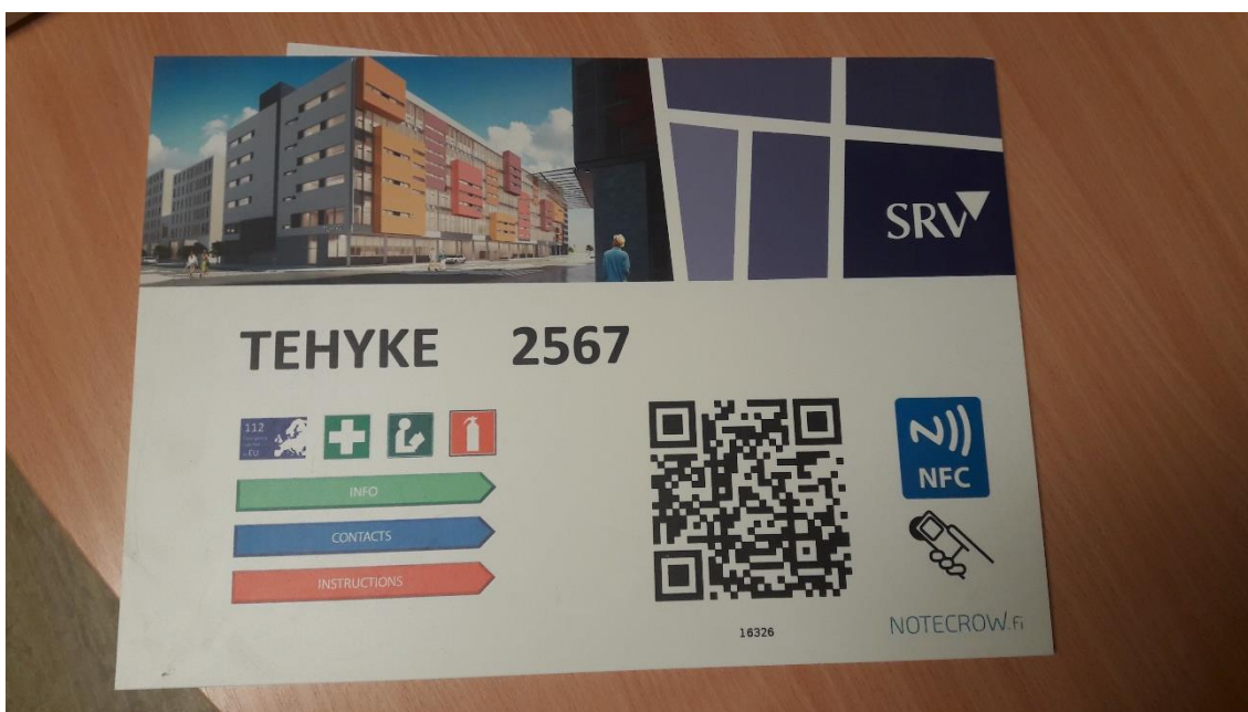
Kuva 9. Työmaalla ollut NFC-koodikyltti
