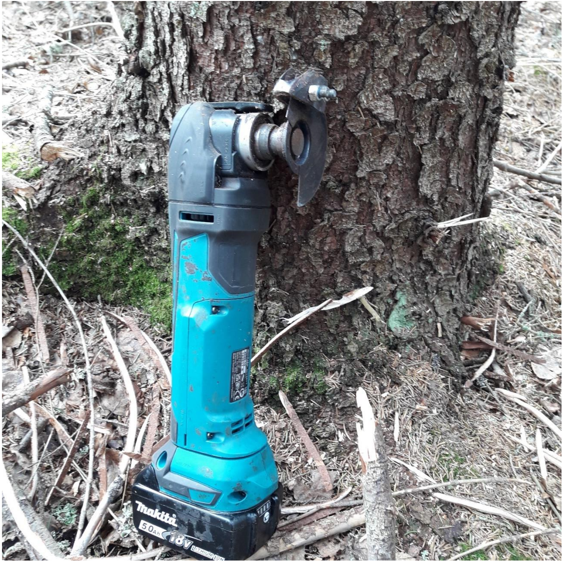
Kuvio 4. Makitan monitoimilaite ja itsevalmistettu terä
