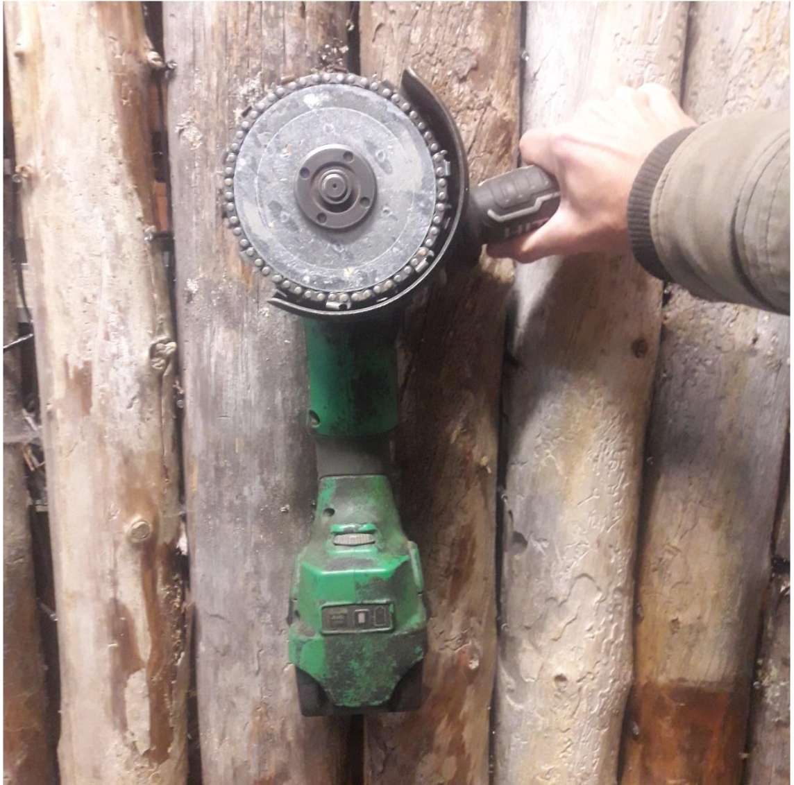
Kuvio 5. Hikokin akkukäyttöinen kulmahiomakone ketjusahaterällä
