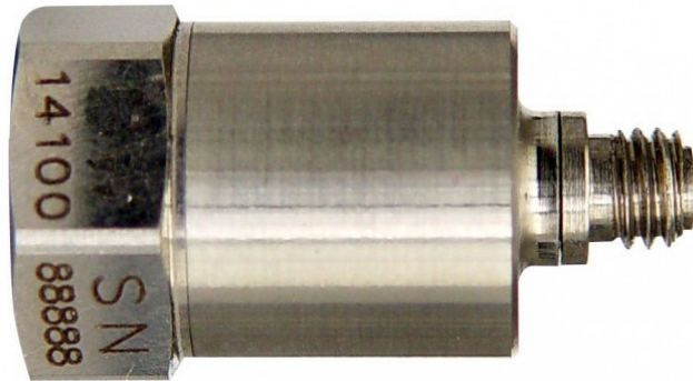
Kuva 18. Kiihtyvyyssanturi, jonka taajuusalue on 0,5 Hz - 10 kHz ja herkkyys 1 mV/ms 2 - 100 mV/ms 2 [23].
