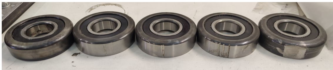
Kuva 35. Ulkokehien laakerivauriot. Vasemmalta oikealle lievimmästä vauriosta suurimpaan: ehjä käytetty laakeri, laakeri 1 (lievin vaurio), laakeri 2, laakeri 3 ja laakeri 4 (suurin).
