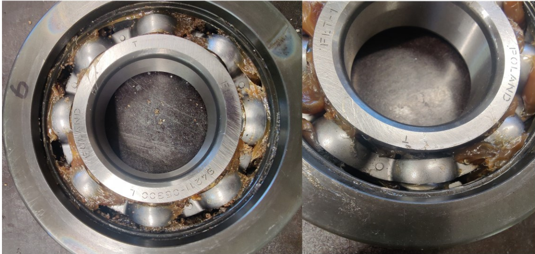
Kuva 36. Vierintäkuulan vaurio oikealla (laakeri 5) sekä hiekoitettu laakeri vasemmalla (laakeri 6).
