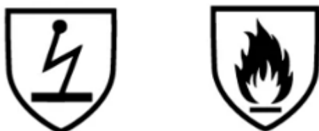
Kuva 5. Suojavaatteiden sähköstaattisia ominaisuuksia sekä kuumuuden ja tulen suoja koskevat symbolit (Tranemo).
