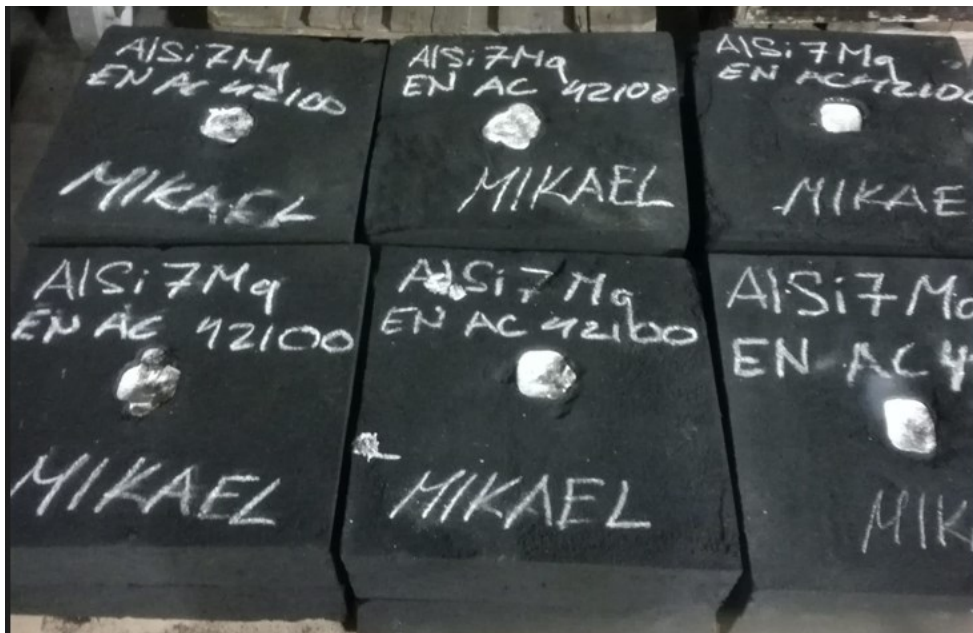
Kuva 18: Valetut vetokoesauvat muotista purettuna.
