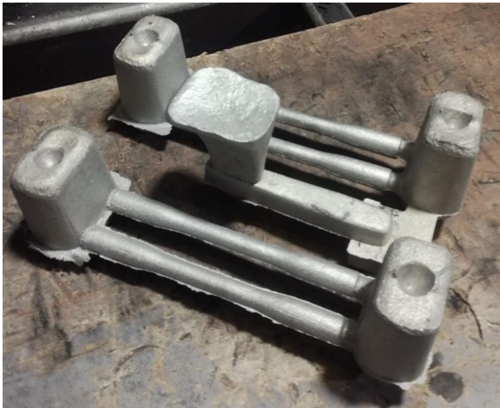
Kuva 18: Valetut vetokoesauvat muotista purettuna.
