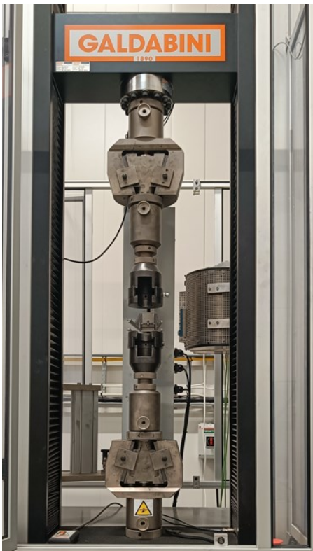
Kuva 20: Galdabini Q200-vetokone (Kehityspäällikkö Minna Kotilainen (Metlab), henkilökohtainen tiedonanto, 14.10.2022).
