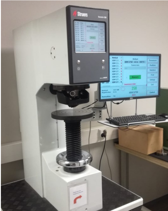
Kuva 21: Brinellin kovuuskone, Metlab.
