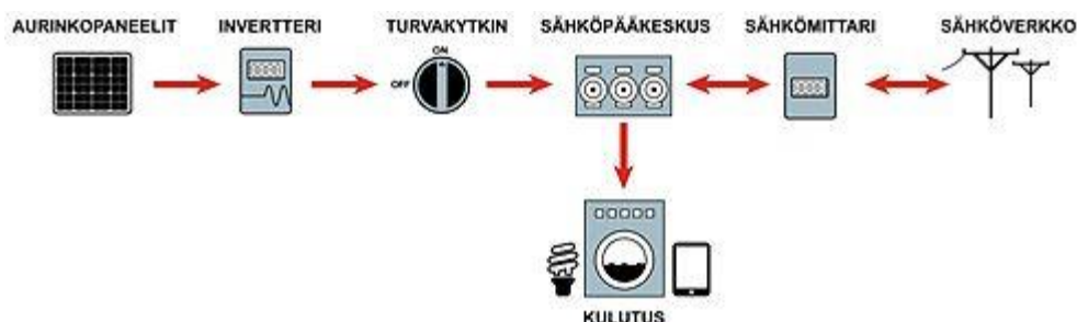
Kuva 3. Verkkoon kytketyn pientalon aurinkosähköjärjestelmän kokoonpano (Motiva, aurinkosähköjärjestelmän mitoittaminen, 2022).
