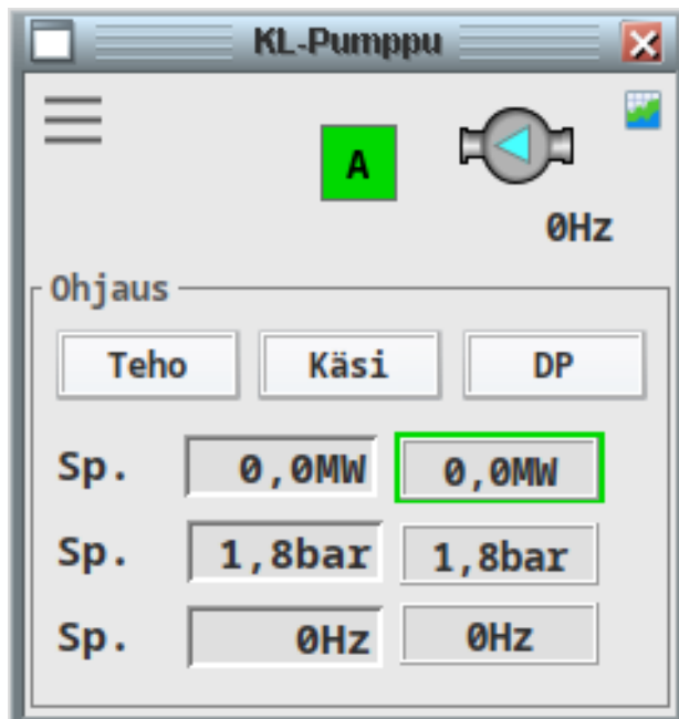
Kuva 20. Kaukolämpöpumpun pop up -ikkuna
