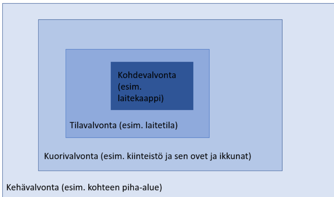
Kuvio 1: Esimerkki murtoilmaisujärjestelmien valvontatavoista (tiedot: Syvälahti ym. 2016)
