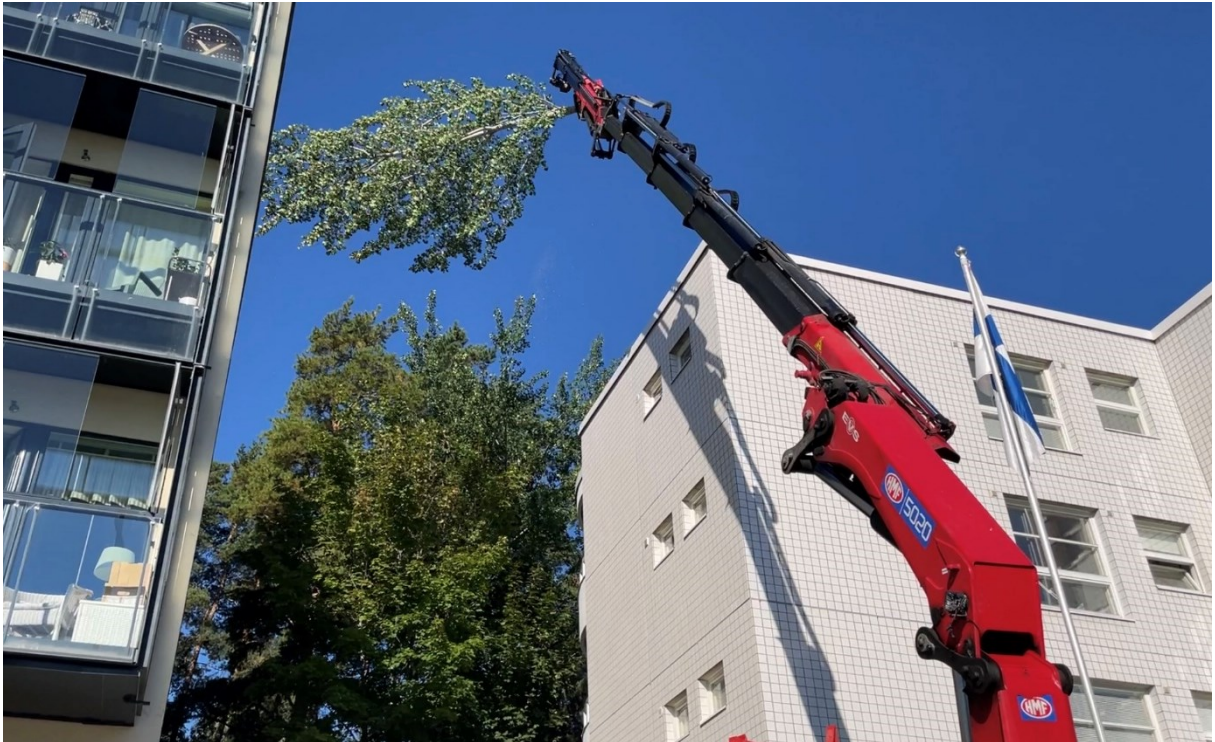
Kuva 3, Kourasaha-autolla saadaan kaadettua puita vaikeista paikoista.
