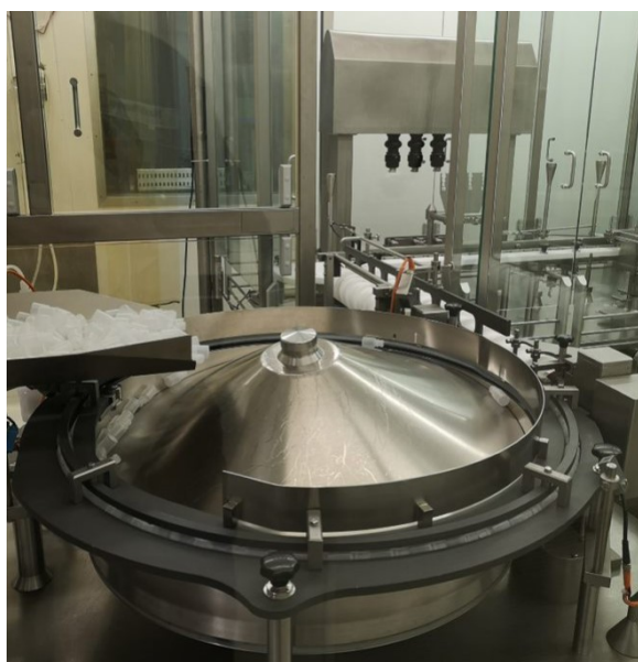
KUVA 6. Pullojen syöttölinja (NextPharma, perehdytysmateriaali, 2022)
