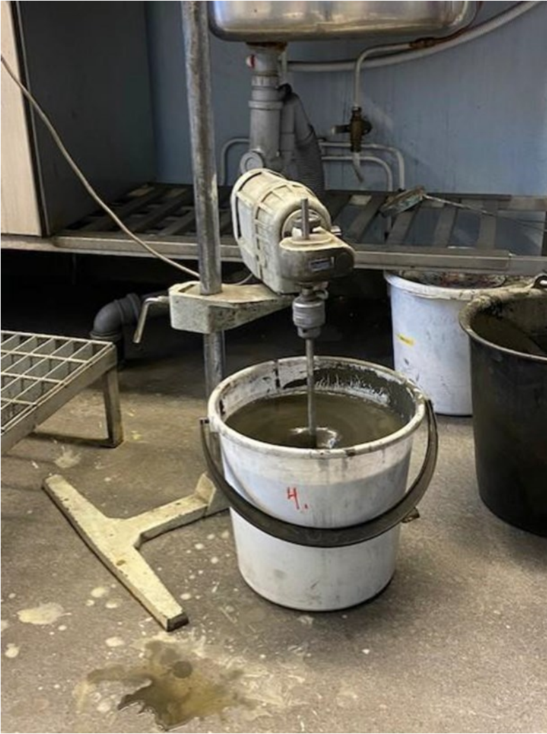
KUVA 5. Prosessijätteen sekoitus mittaussvaiheessa
