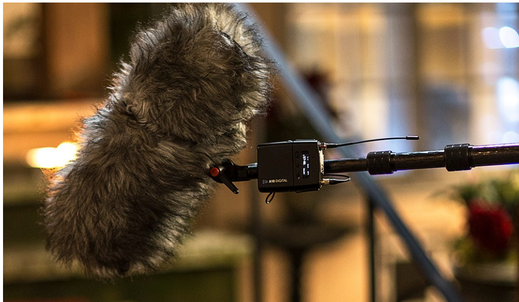
Kuva 2 Sound Devices A10 Lähetin puomimikrofonin lähettimenä
