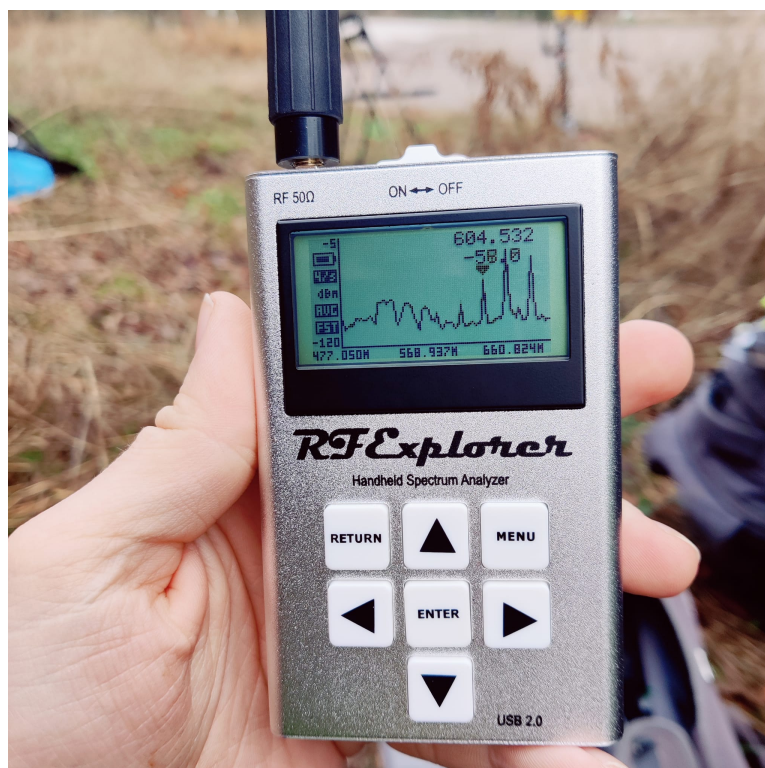
Kuva 36 RF Explorer, spektrianalysaattori. Spektrissä vasemmalla näkyvät tasaiset huiput, ovat TV-kanavia. Oikealla näkyvät terävät huiput ovat radiolähettämiä. TV-Kanavien ja kolmen lähettimen välissä oleva matala terävä huippu, on lähettimien muodostama intermodulaatio.
