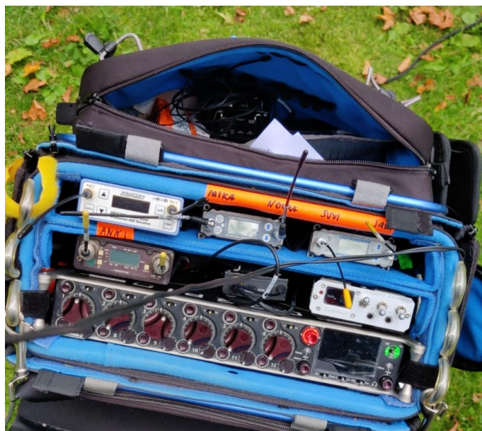
Kuva 12 Äänilaukku, joka on rakennettu valjailla kannettavaksi. Kaikki vastaanottimet toimivat piiska-antenneja hyödyntäen.
