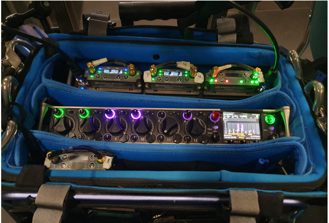
Kuva 5 Äänikärnyssä oleva laukku, jossa äänittimenä toimii Sound Devices Scorpio, ja langattomia ovat neljä Wisycomin MCR42 vastaanotinta.
