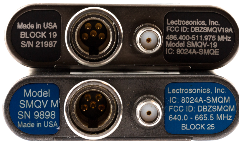
Kuva 30 Lectrosonicsin SMQV lähettimiä. Ylempi blokkia 19 ja alempi blokkia 25
