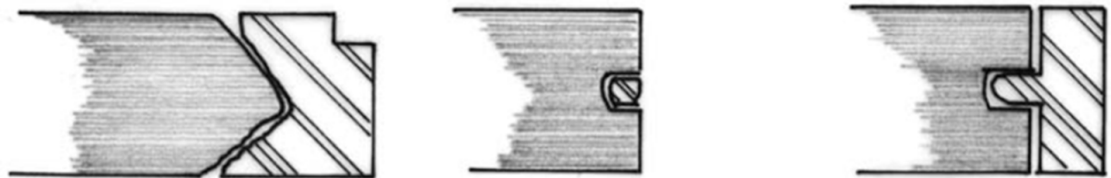
Kuva 10. Karatyyppit. Ikkunoissa käytetyt karatyyppit kehittyivät ajan myötä. Soron päärakennuksessa on käytetty keskimmäistä mallia eli kielikaraa. (Jokelainen 2005, 116)
