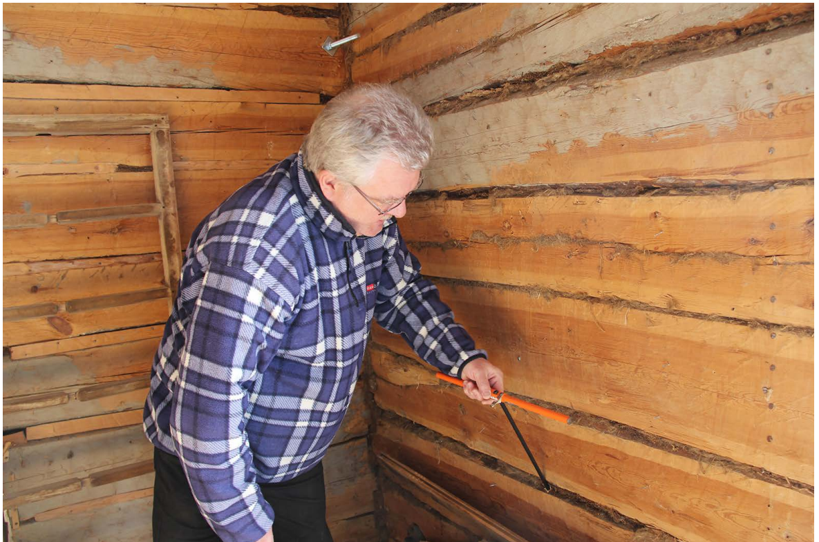
Kuva 16. Näytteiden kairaus. Kvartääri-geologi Pentti Zetterberg kairaamassa ajoitusnäytettä Soron päärakennuksen ulkoseinästä. Kuva: Tuovi Rautjoki.
