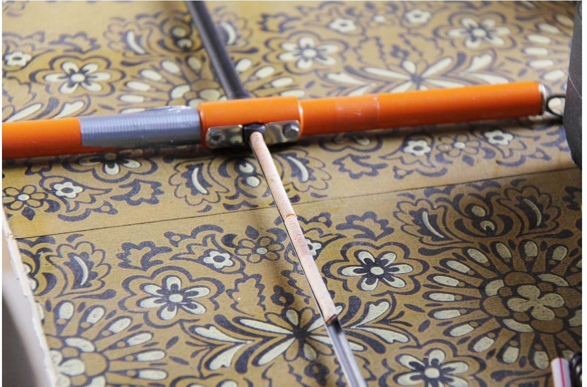
Kuva 19. Hirrestä juuri otettu kairauslastu. Kuva: Tuovi Rautjoki.
