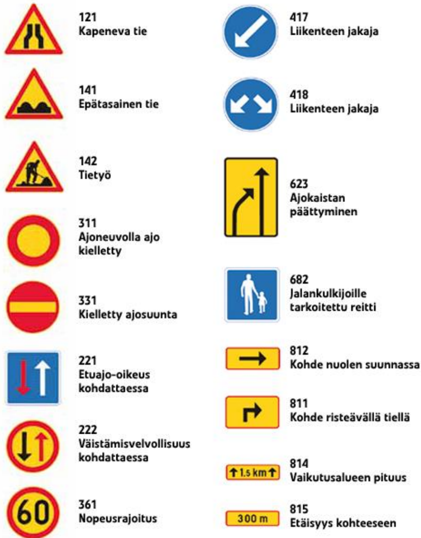
Kuva 3. Verkostotyömaiden yleisempiä liikennemerkkejä (TTK, liikennejärjestelyt verkostotöissä 2011, 20)
