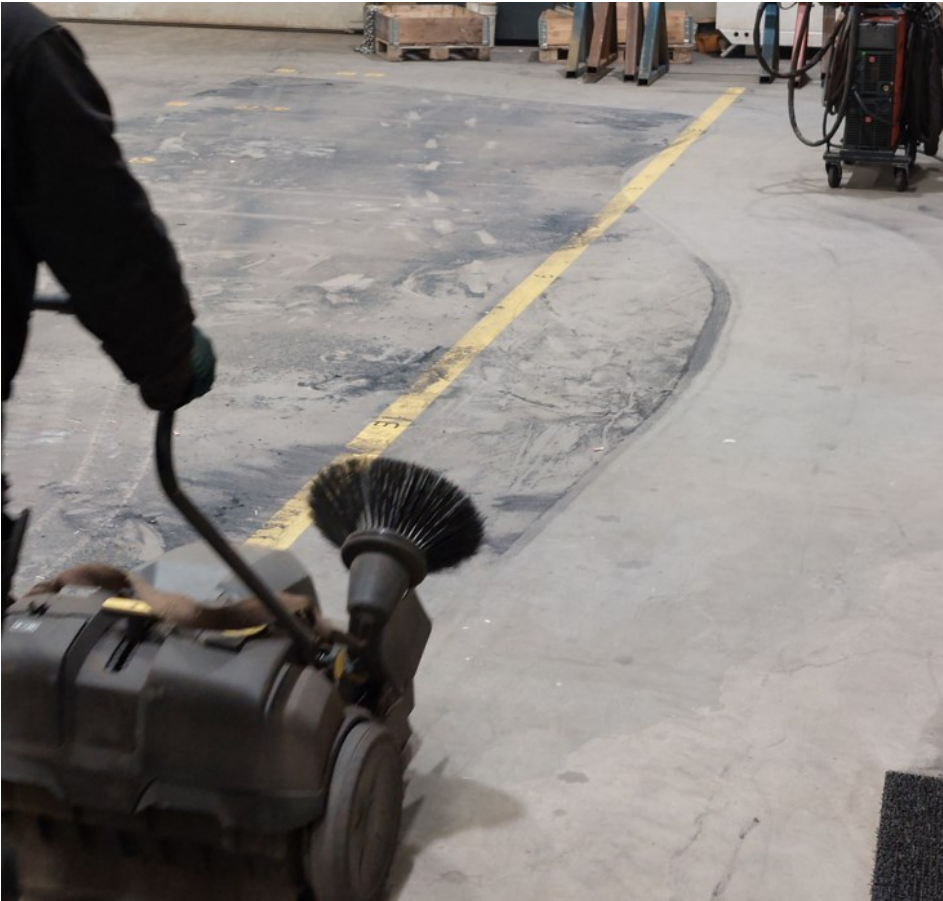
Kuvio 11. Velvoitettu lattioiden puhdistaminen työn valmistumisen jälkeen imulakaisukoneen avulla käyn nopeasti ja tehokkaasti.
