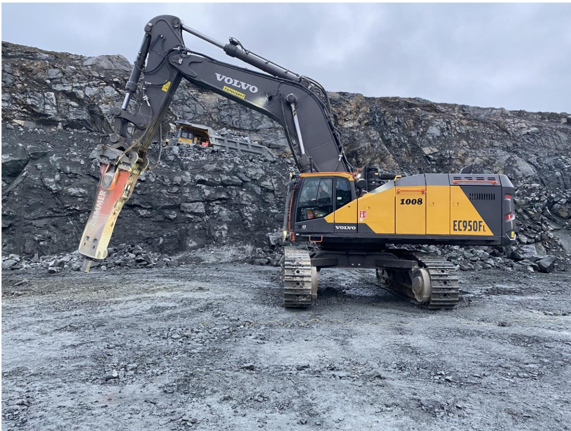
KUVA 2. Yleiskuva työkoneesta ja hydraulivasarasta
