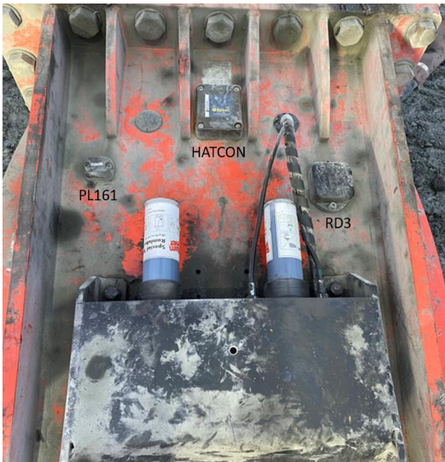
KUVIO 4. Kolmen eri valmistajan mittalaitteet kiinnitettynä hydraulivasaraan
