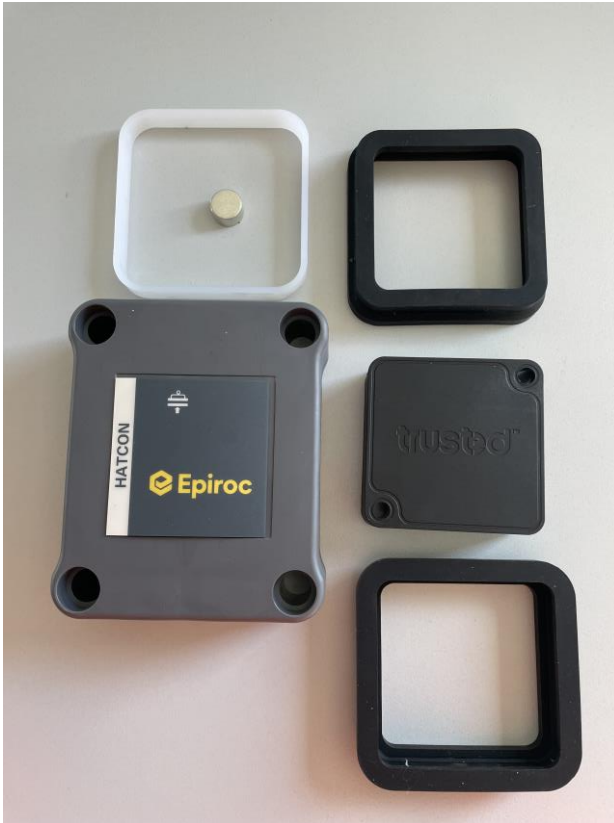
KUVA 6. HATCON:in mittalaite purettuna ja aktivointi magneetti
