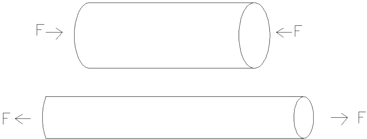
KUVA 7. Venymäliuska-anturissa puristava voima F vaikuttaa langan muotoon
