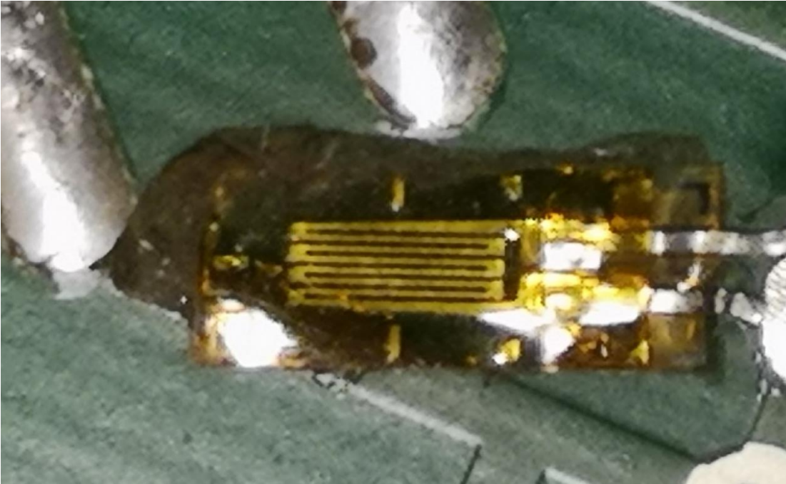
KUVA 9. Venymäliuska liimattuna kappaleeseen, kappaleen muodon muuttuessa liuska venyy tai puristuu, minkä takia liuskan resistanssi muuttuu.
