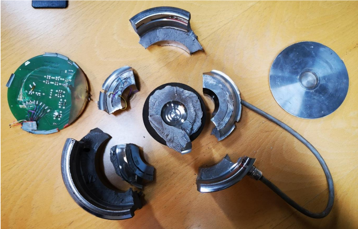
KUVA 11. Rikkinäinen ruostumattomasta teräksestä valmistettu punnitusanturi
