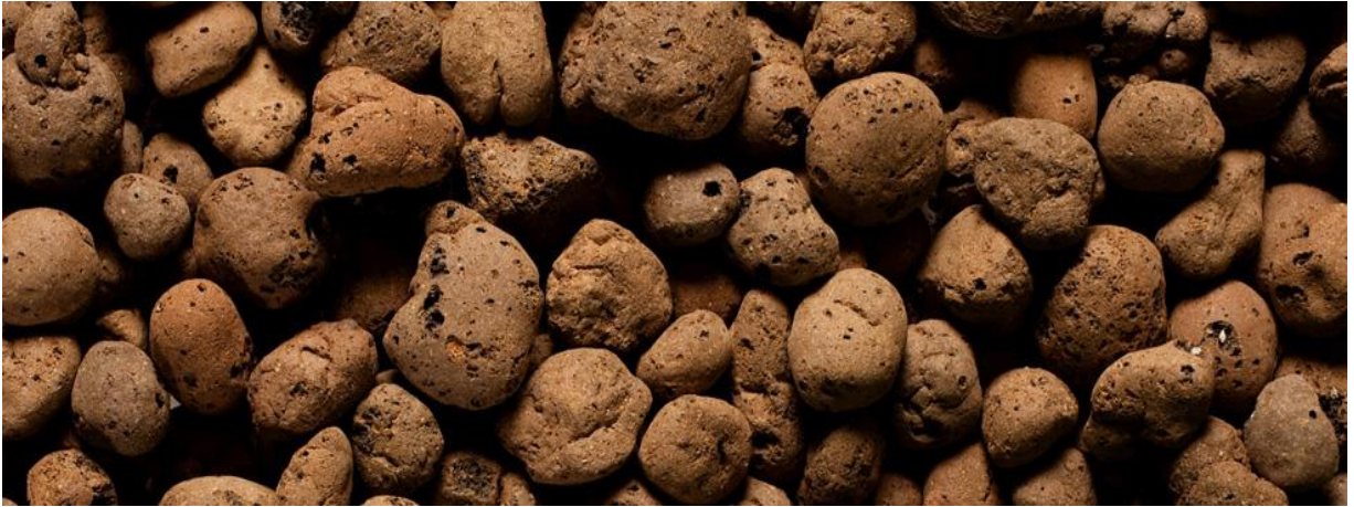
KUVA 10. Kevytsora on tasarakeista ja erittäin kevyttä, vain noin 500 kg/m 3
