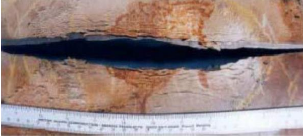
Kuva 14. SCC korkeapaineisessa ja halkaisijaltaan suuressa kaasunsiirtoputkessa [11, s.3].
