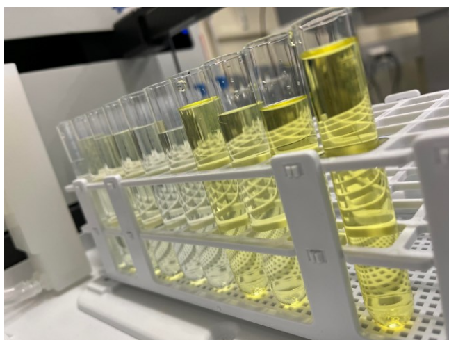
KUVA 7. Mustalipeänäytteet mikroaaltouunihajotuksen jälkeen valmiina ICP-OES-laitteelle syöttöä varten.
