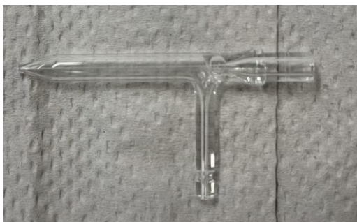
KUVA 2. ICP-OES-laitteen kvartsinen sumutin.
