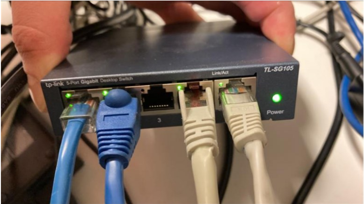
Kuva 6. TP-Link TL-SG105 verkkokytkin
