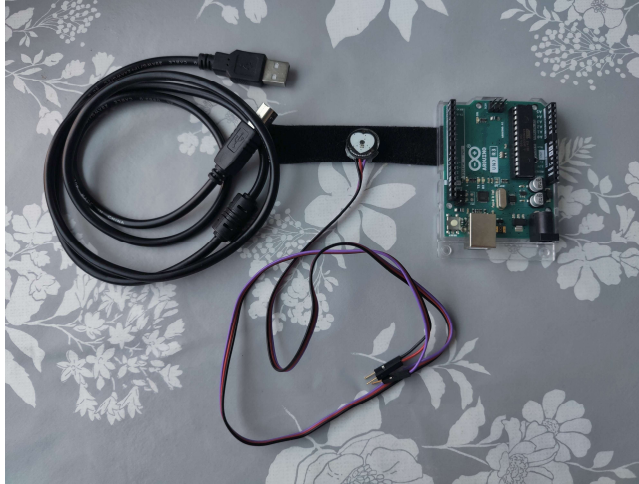
Kuva 12. Projektin lopullisen sykkeenseurantalaitteiston osat: Arduino Uno -ohjaukortti oikealla kuvassa ja PulseSensor-sensori keskellä.
