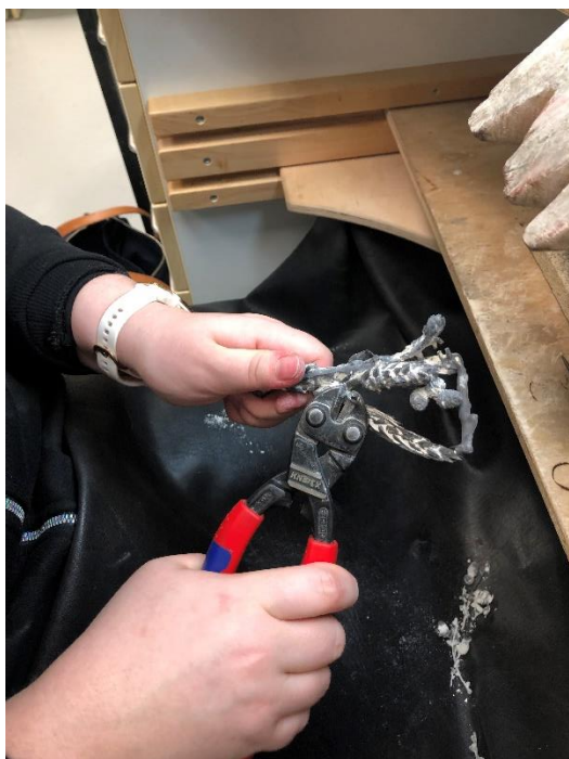
KUVA 22. Kappaleiden irrottaminen valupuusta.
