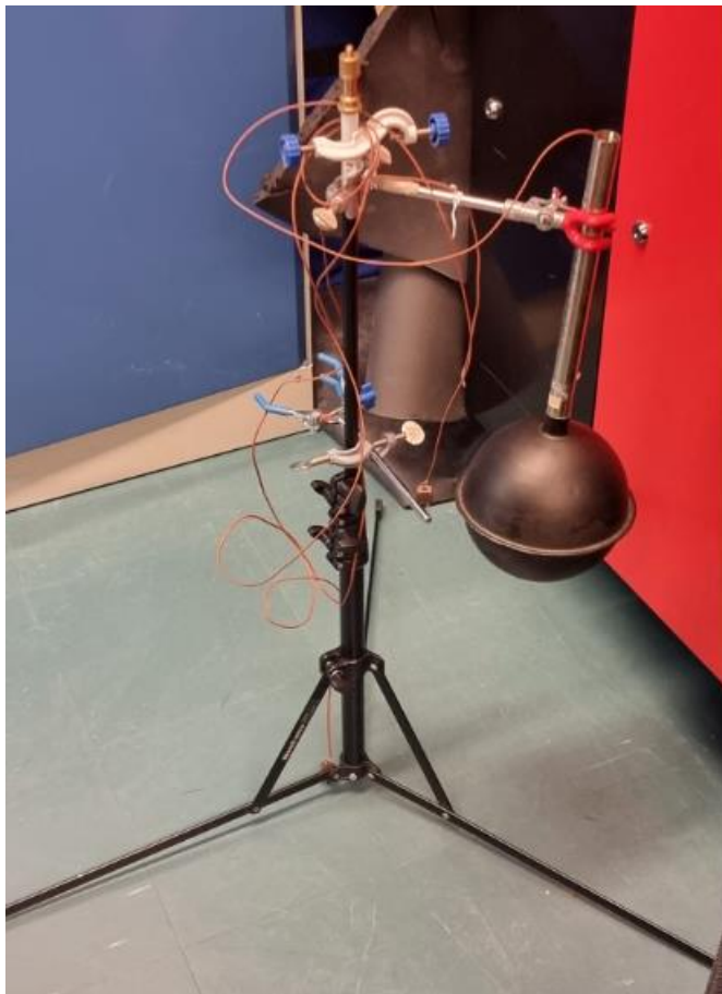
Kuva 6. Mustapallo operatiivisen lämpötilan mittausta varten
