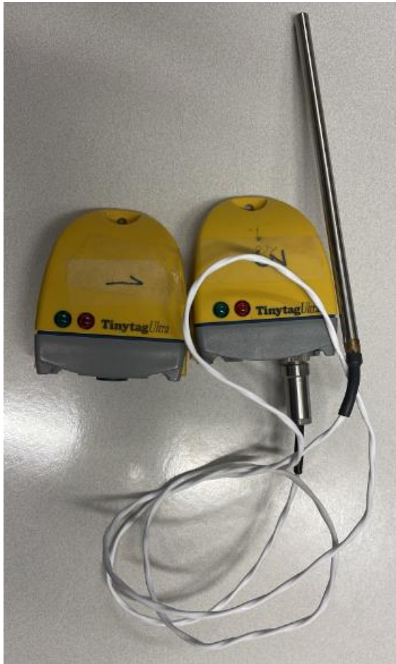
Kuva 5. Loggereita, joilla lämpötiloja tallennettiin
