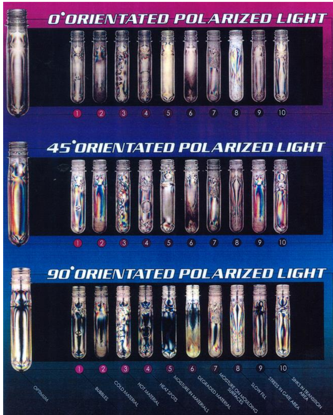
KUVIO 15. Preformin vikojen tunnistus polarisoidun valon avulla (R&D Tool & Engineering Group)
