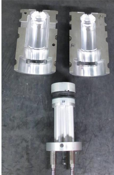
KUVIO 12. Puhalluskoneen muotin osat (Sinebrychoff 2014)
