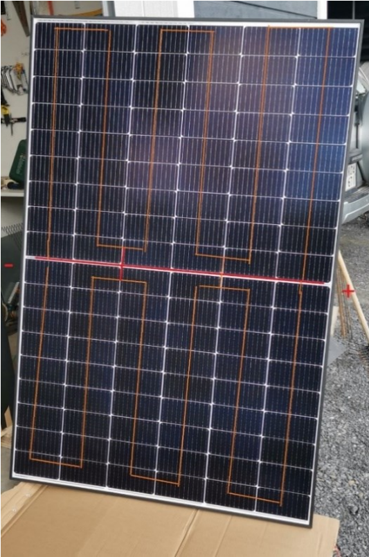
Kuva 3. Half cut paneelin virtapiiri (Hautamäki, 2022).
