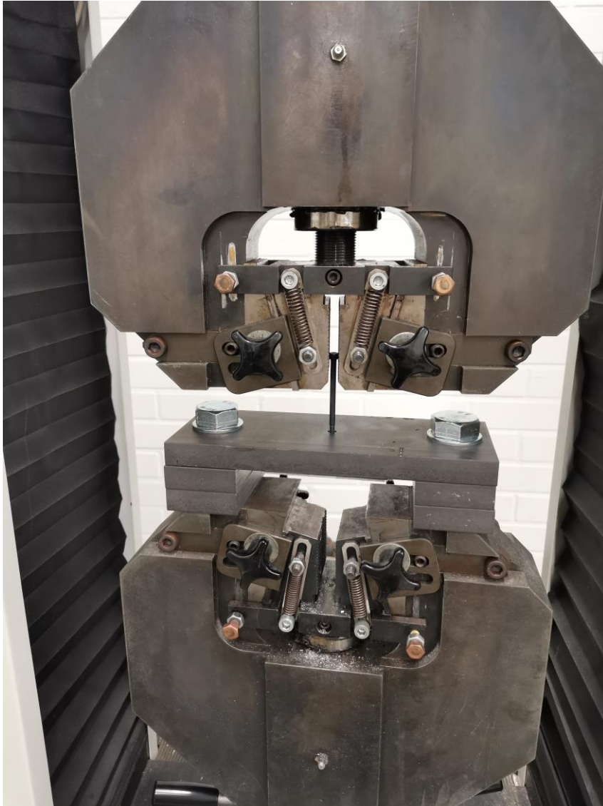
Kuva 24. Vetokone ja testijigi, johon on asetettu testikappale vetokoetta varten.
