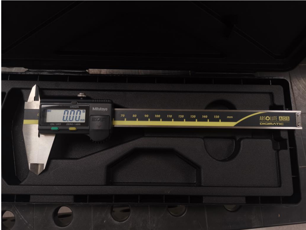
Kuva 29. Työntömitta, jolla mitattiin välikierreholkkien reiän syvyyttä.
