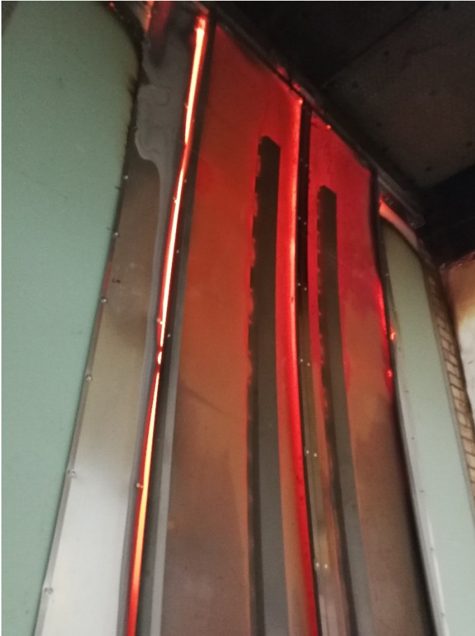
Kuva 10. Erikoiskorkea hissinovi huuvan sisältä EN 81-58-testissä (Anttila 2022).
