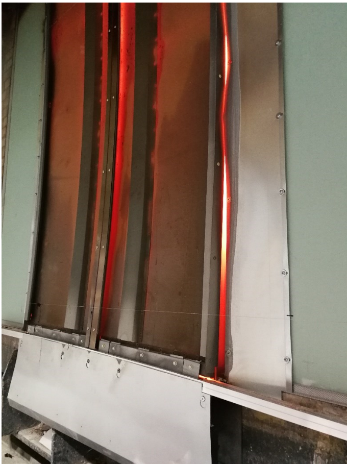
Kuva 11. Erikoiskorkea hissinovi huuvan sisältä EN 81-58-testissä (Anttila 2022).
