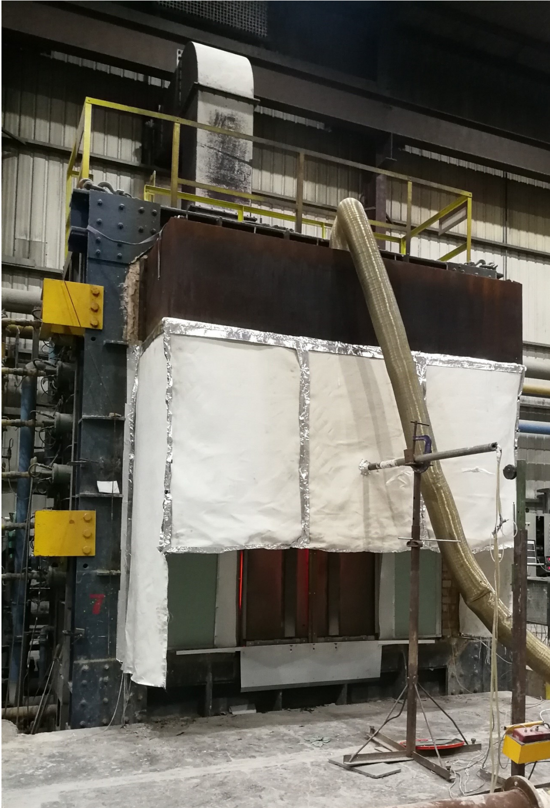
Kuva 9. EN 81-58 testin järjestelyt gipsilevyseinän testauksessa (Anttila 2022).
