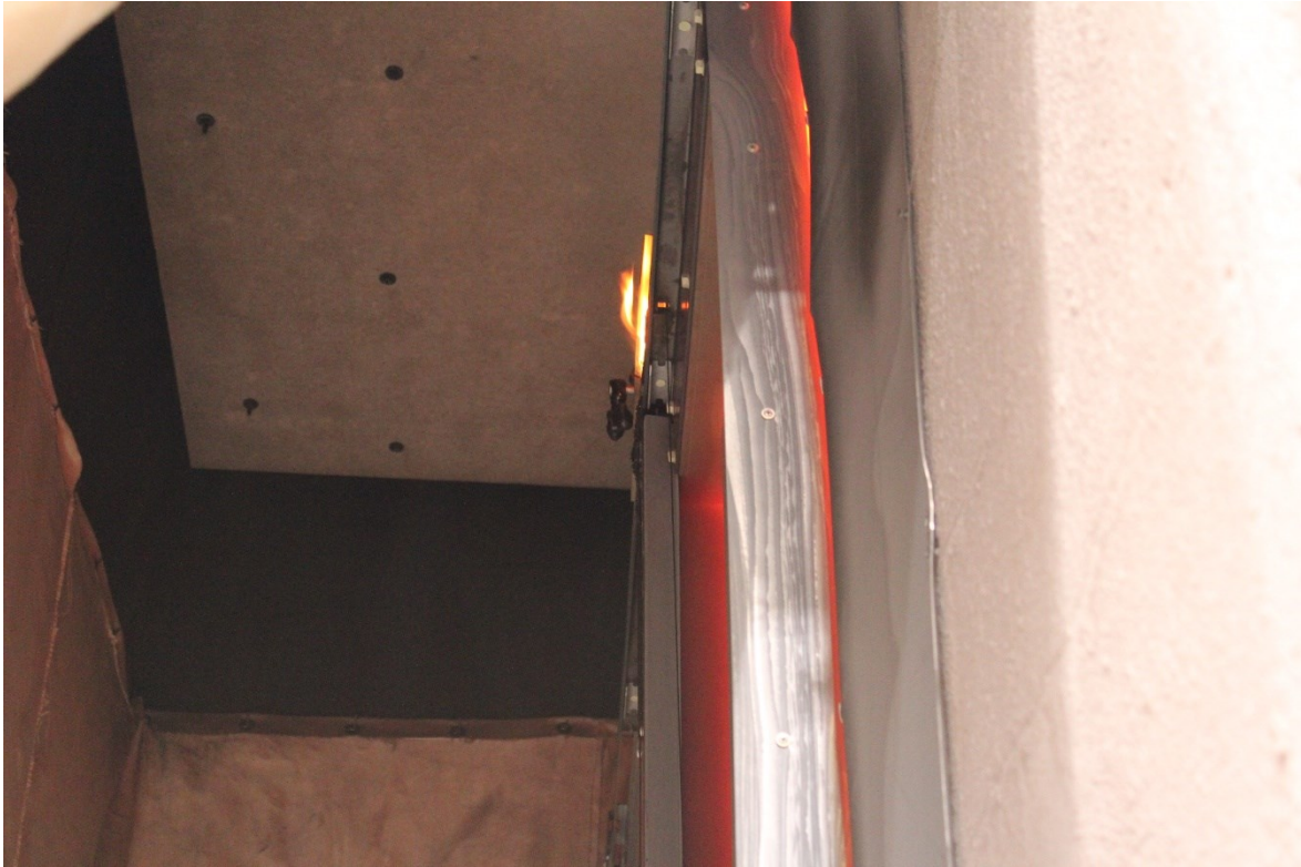
Kuva 7. Liekki EN 81-58 testauksessa (Anttila 2022).
