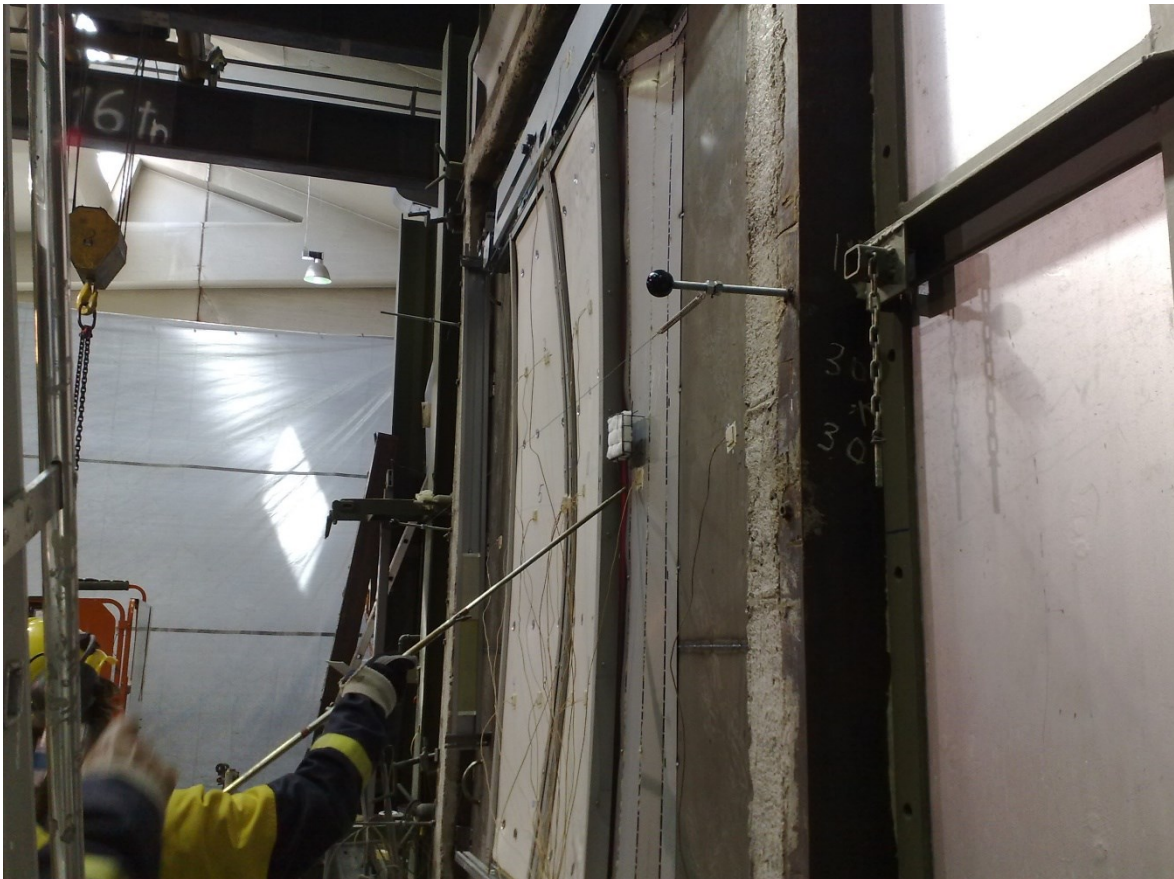
Kuva 14. Vanutyyntällä mittaus mahdollisesta vuotopaikasta BS476 (Anttila 2022).
