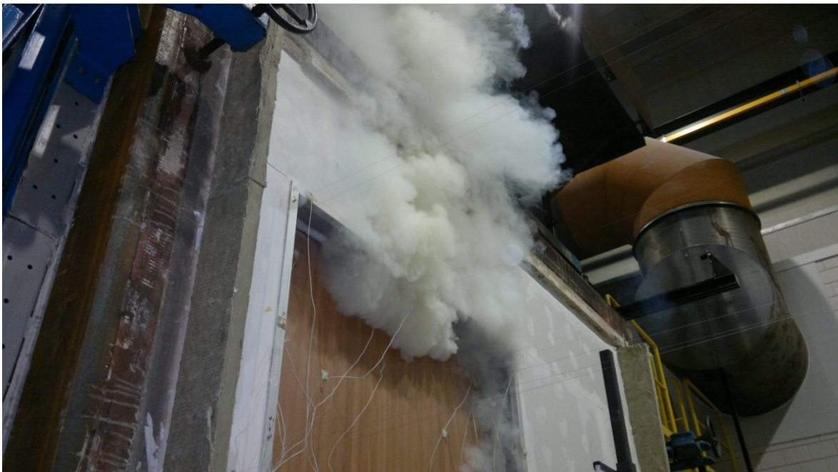
Kuva 8. Palo-oven EN 1634-1 testausjärjestelyt kipsilevyseinässä (Anttila 2022).
