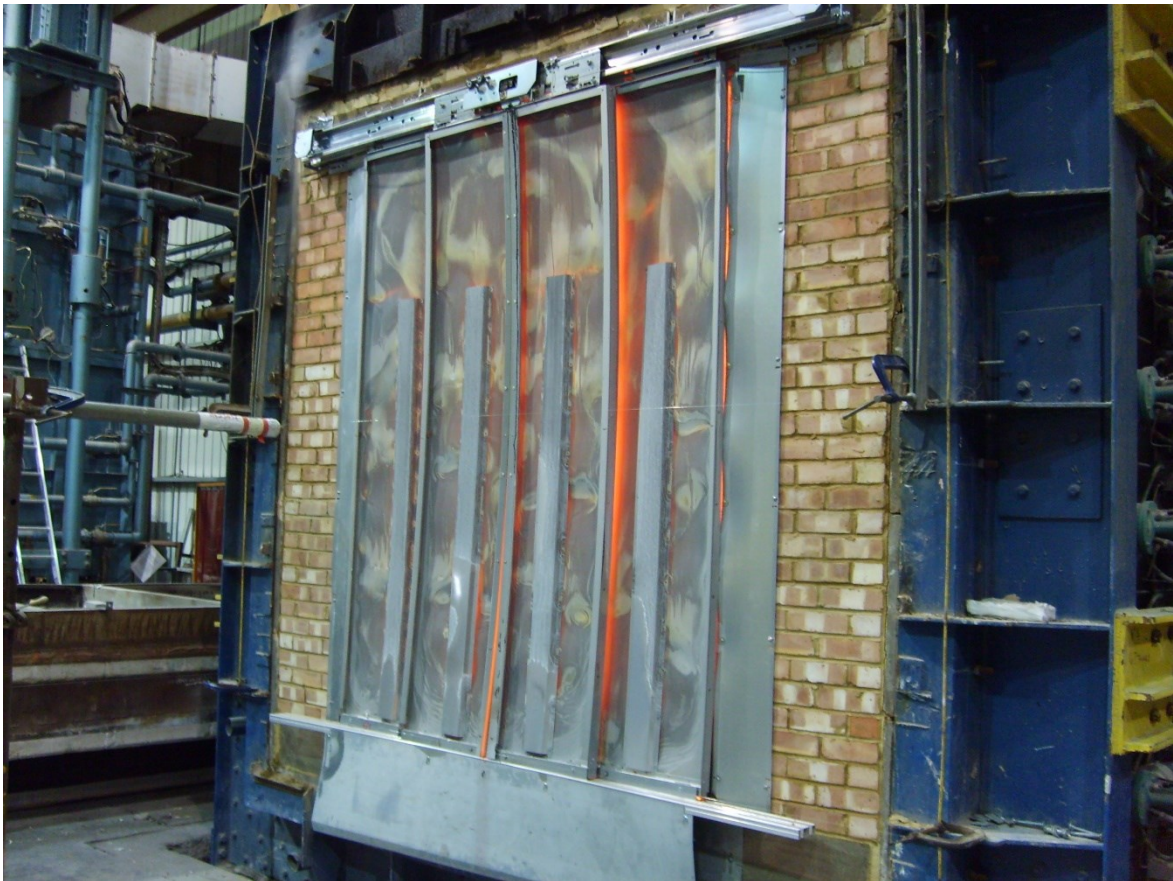
Kuva 12. BS476 testauksen yleisjärjestelyt eristämättömälle hissin palo-ovelle (Anttila 2022).
