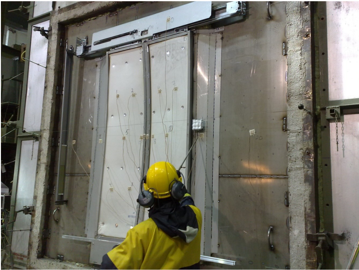
Kuva 13. Vanutyyntällä mittaus mahdollisesta vuotopaikasta BS476 (Anttila 2022).
