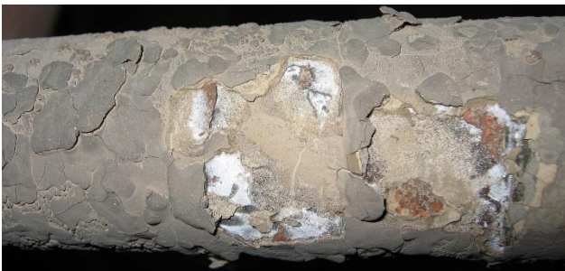
KUVA 11 & 12. Biomassan ja muovijätteen seospolton aiheuttama korroosio tulistinpinnalla sekä ammoniumsulfaatin lisäys poltettaessa samaa polttoaineseosta (Vattenfall 2022)
