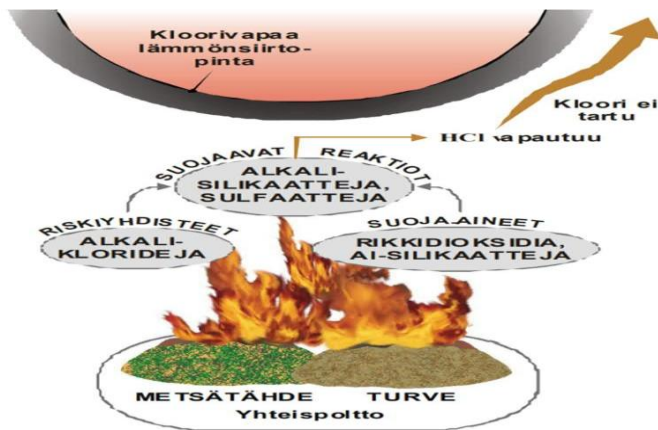
KUVA 10. Periaatekuva puun ja turpeen seospoltosta (Alakangas ym. 2016, 201)
