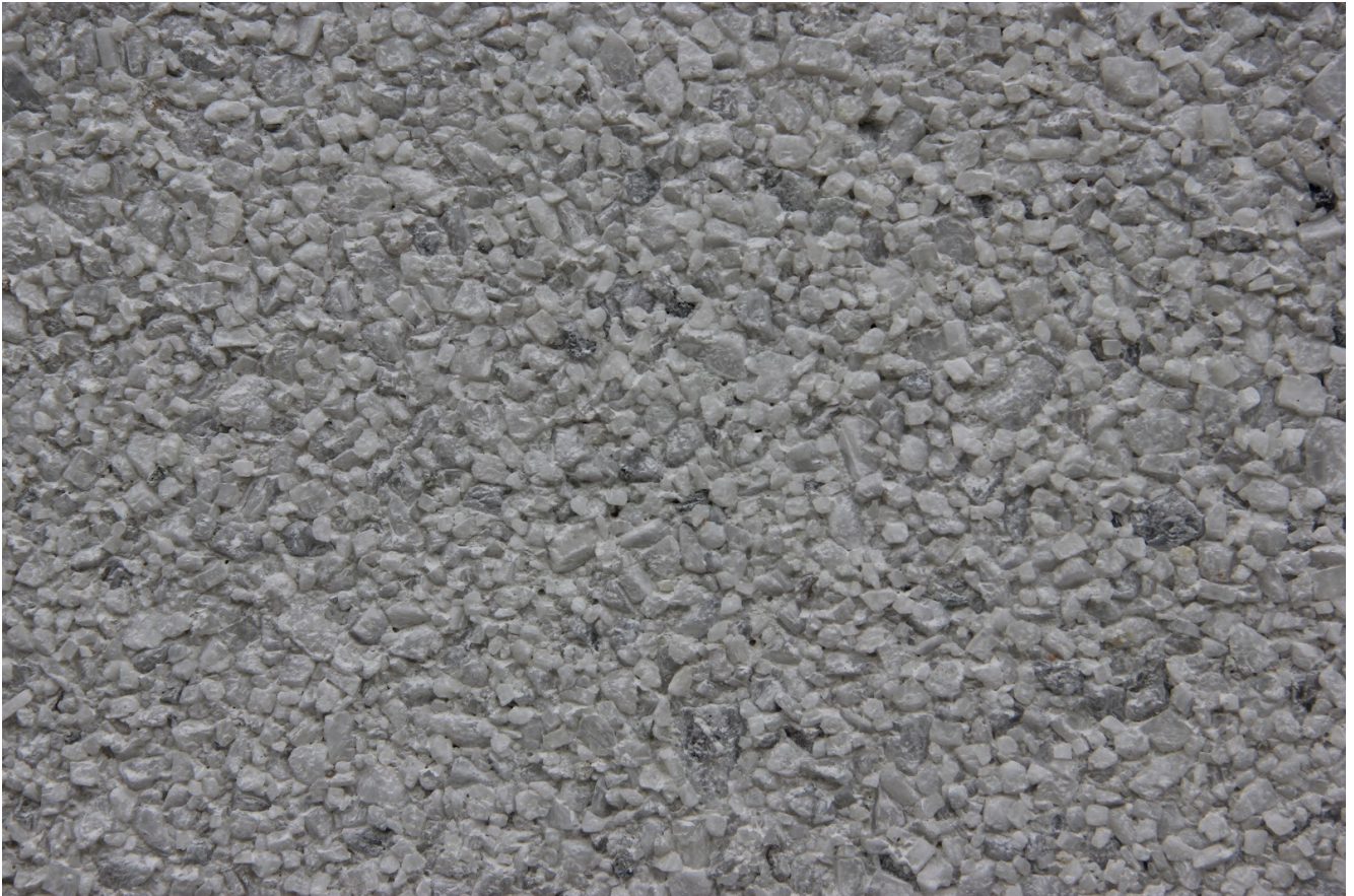
Kuva 9. Valkobetoni pesupinnalla (Hintikka, 2013).
