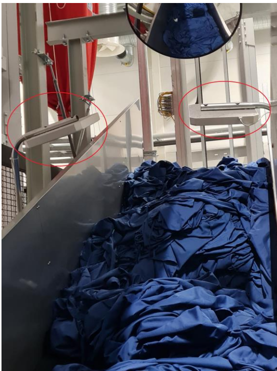
Kuvio 12. Silojen alapuolella sijaitsevat RFID-antennit
