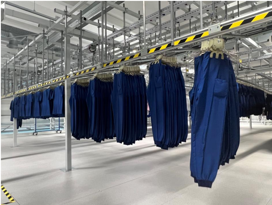
Kuvio 24. B-varasto. Kuvassa järjestelmä on suorittanut työvaatteiden lajittelun tuotetyypin sekä koon mukaan
