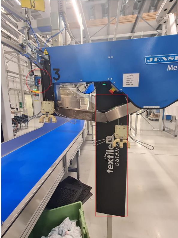
Kuvio 21. Syöttöasema. Kuvassa neliöitynä RFID-lukija sekä ympyröitynä viivakoodilukija
