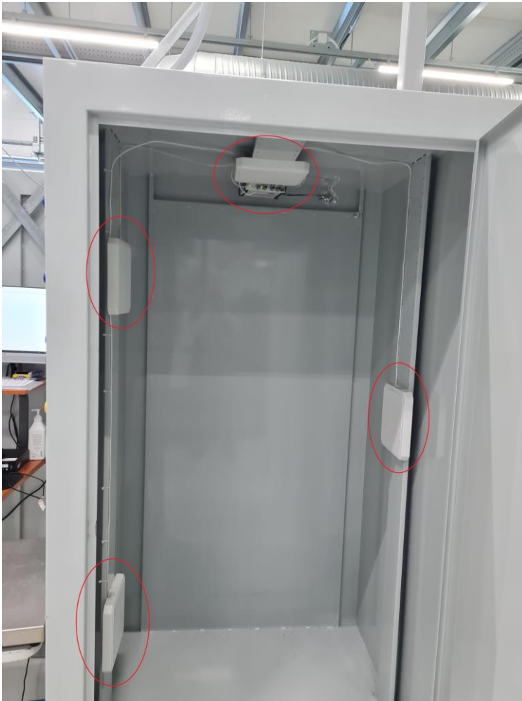
Kuvio 25. Metallikaappi, jossa lukija sekä antennit sijaitsevat
