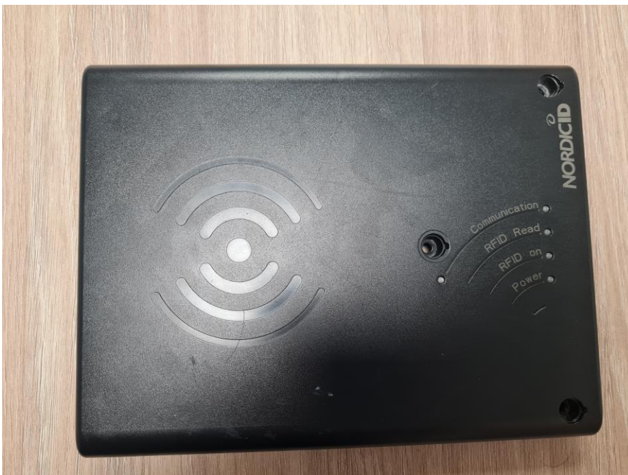
Kuvio 26. USB-porttiin kytkettävä RFID-lukija
