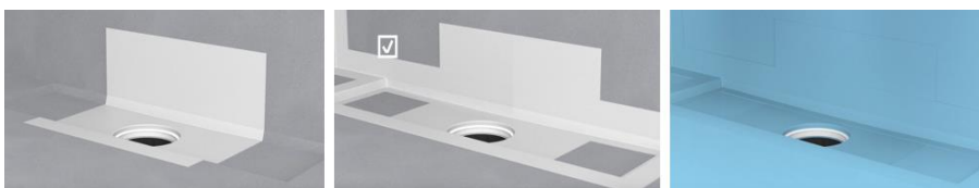
Kuva 30 Vedeneristys liitetty suoraan lattiakaivoon (liska Kaukola-Risku, 2022)
