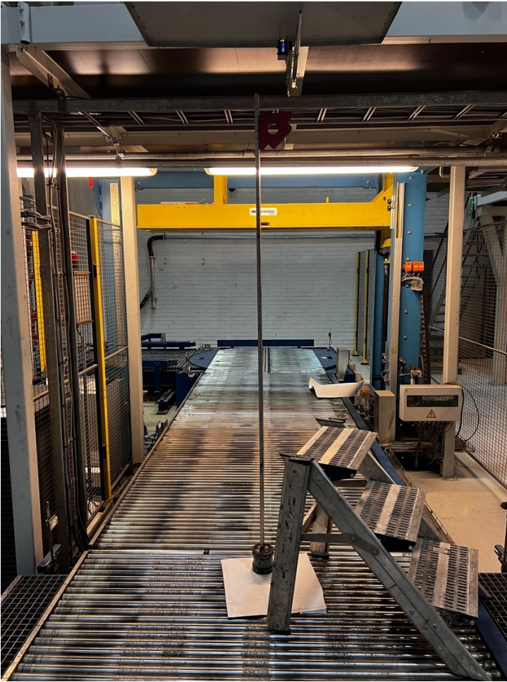
Kuvio 12. Anturin mittausalueen alarajan kalibrointi sekä kalibrointiin käytettävä työkalu
