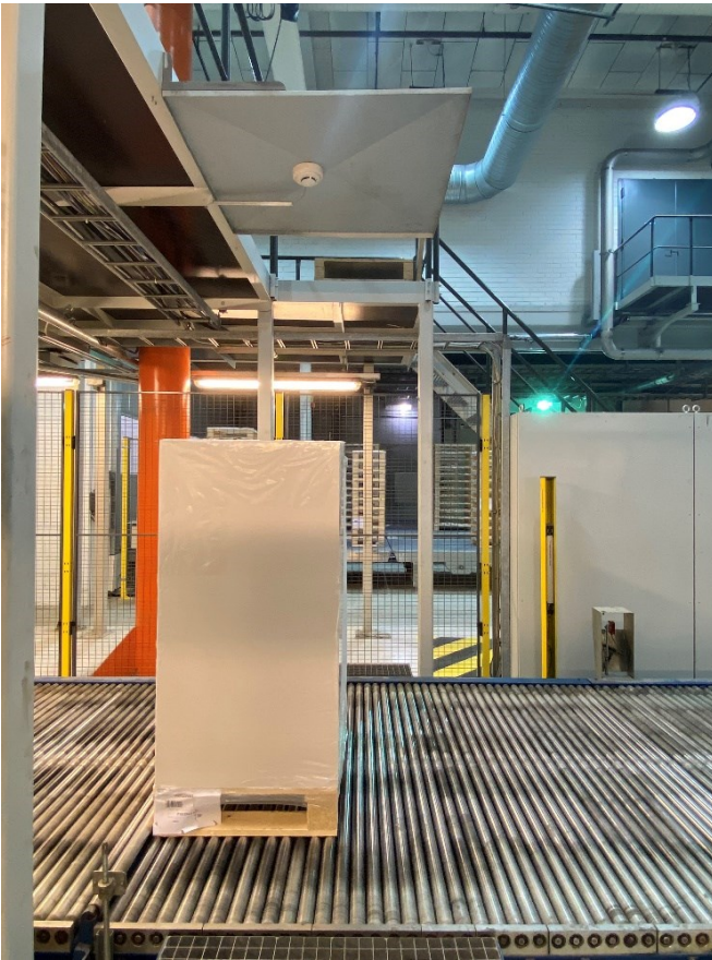
Kuvio 6. Uuden korkeudenmittauspisteen anturin suunniteltu asennuspaikka prosessissa
