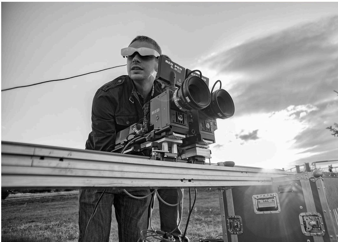
Kuva 2. Paralleeririgi jossa kaksi Red Epic -kameraa (Kuva: Isyrius. Lupa 12.10.2013).
