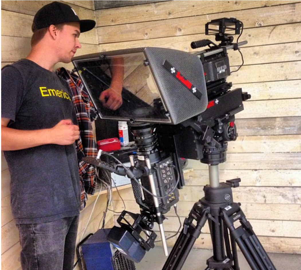
Kuva 4. Camp Räsälä -projektissa käytetty beamsplitter rig, jossa kaksi Red One -kameraa (Kuva: Antti Lampinen. Lupa 12.10.2013).
