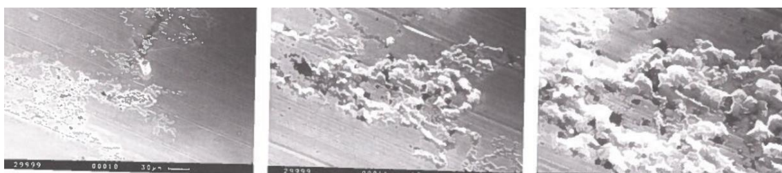
KUVA 6. Epäsopivien lisäaineiden yhdistelmä syövyttää metallipintoja (Antila, & ym. 2013. 36).
