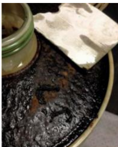
KUVA 9. Lakkautumistuotteiden kertyminen suodatinpatruunaan (12.1.2023).
