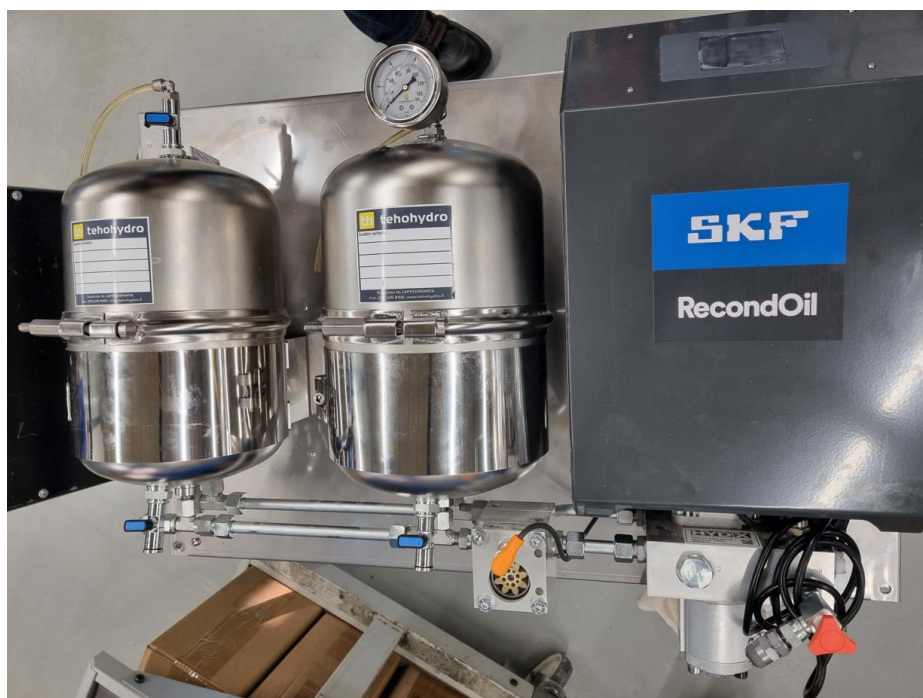
KUVA 42. RecondOil- öljynpuhdistuslaite. Kaksi erillistä suodatinyksikköä (27.1.2023).
