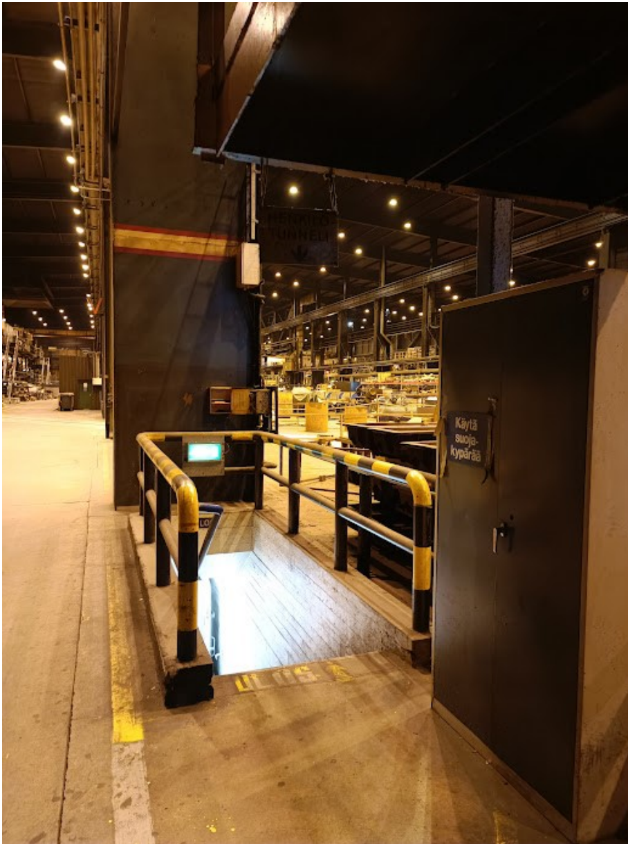
Kuva 18. Henkilöstötunnelin suuaukko (Väistö, M. 2023)
